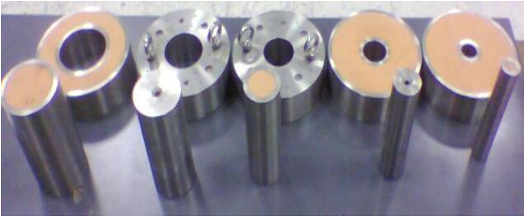
Şekil 4.3 : Üst Başlıklar ile 20, 30, 40, 50, 60 mm çapında Pistonlar.
