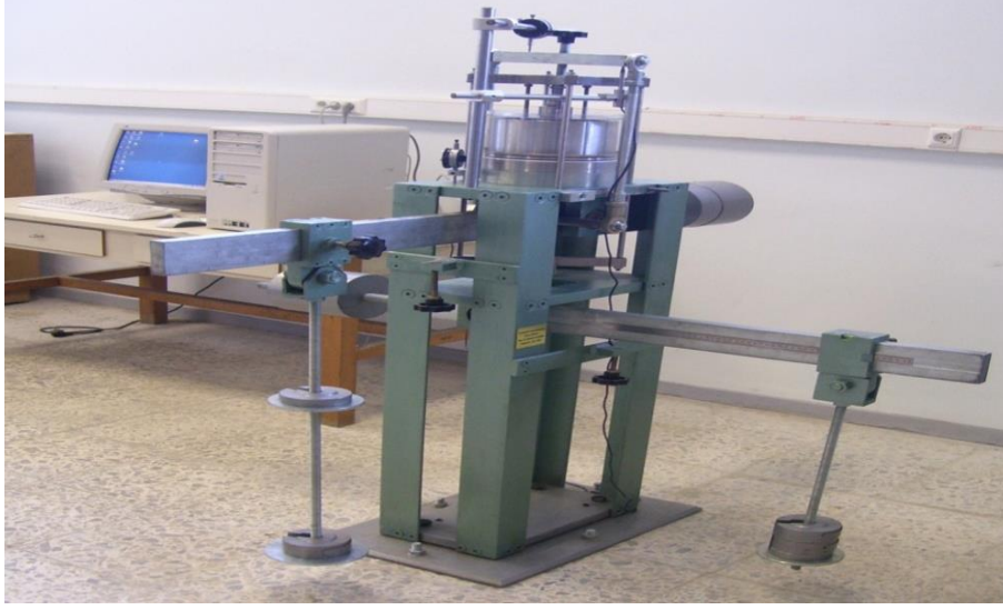
Şekil 4.2 : Üç Boyutlu Konsolidasyon Deney Aleti.
