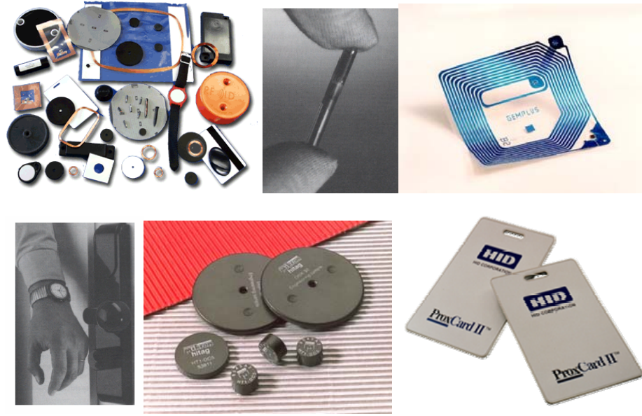
Şekil 2.11: RFID etiketlerin farklı kullanım şekilleri (Finkenzeller, 2002)
