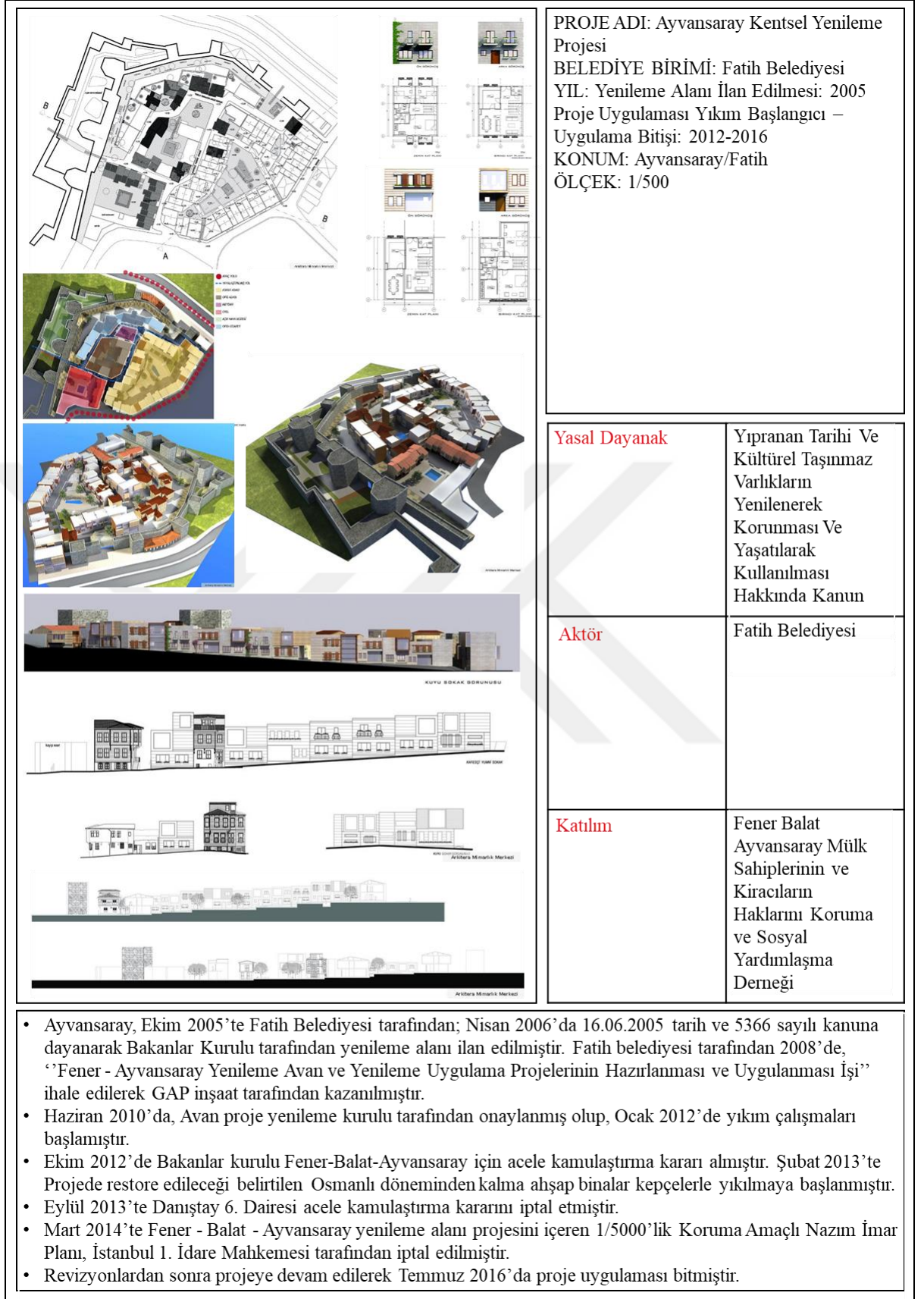
Şekil 4.6 : Ayvansaray kentsel yenileme projesi.
