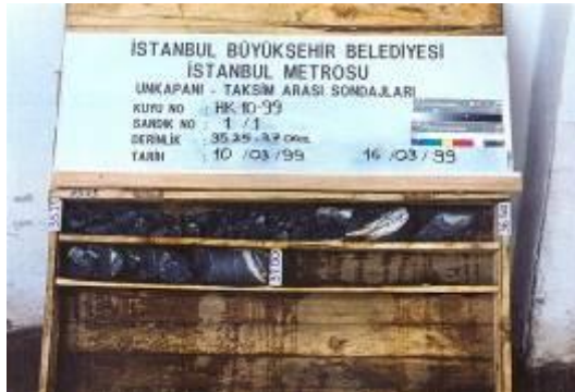
Şekil B-3 : P3-1 ve P3-3 ayakları karot sandığı fotoğrafları (Üstteki 4 fotoğraf; P3-1, alttaki 4 fotoğraf; P3-3'e aittir).
