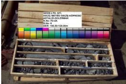
Şekil B-2 : P2-2 ayağı karot sandığı fotoğrafları.
