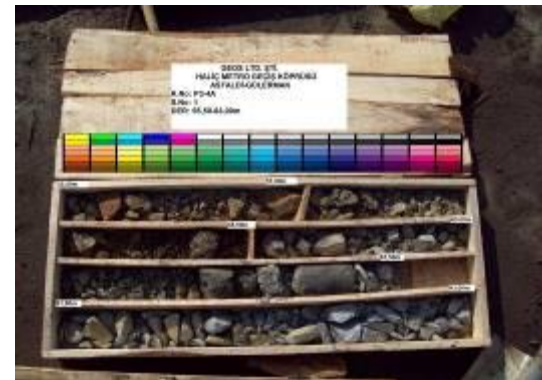
Şekil B-5 : P3-4 ayağı karot sandığı fotoğrafları.
