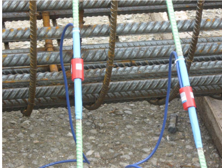
Şekil D-5 : P3-4B no.lu kazıkta donatıya 7 farklı kademede akuple edilen deformasyon ölçerler ( sister bar-strain gauge).
