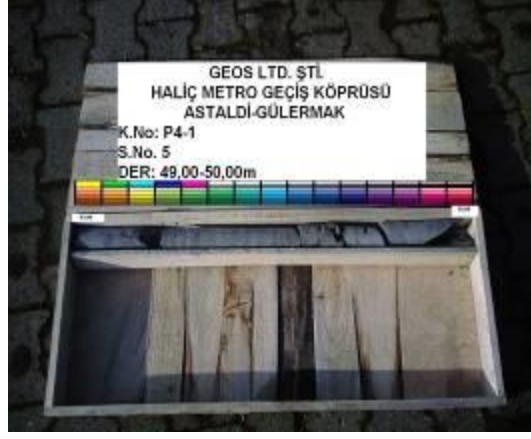
Şekil B-8 : P4-1 ayağı karot sandığı fotoğrafları.
