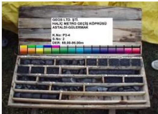
Şekil B-5 : P3-4 ayağı karot sandığı fotoğrafları.
