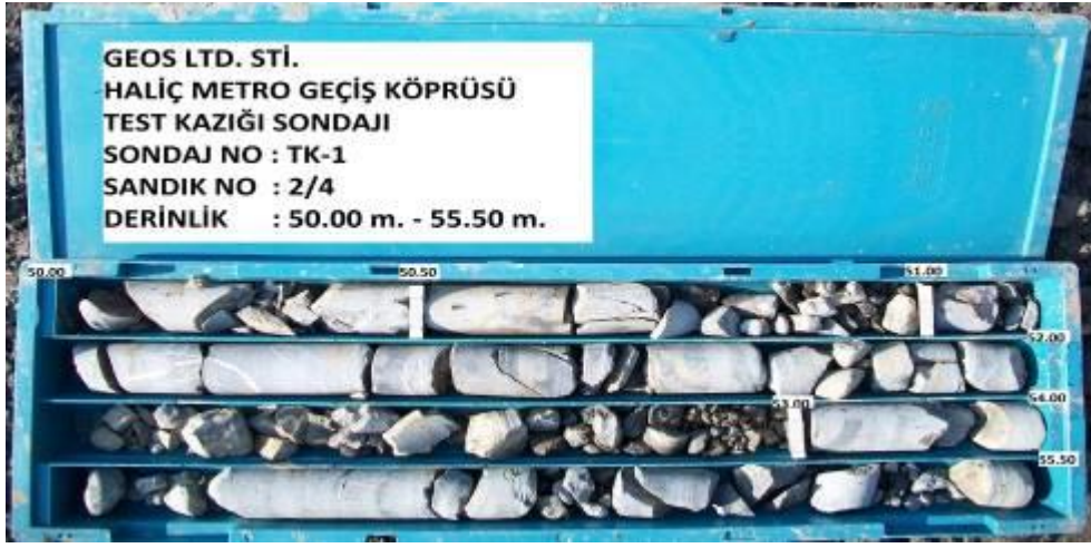
Şekil B-8 : P4-1 ayağı karot sandığı fotoğrafları.
