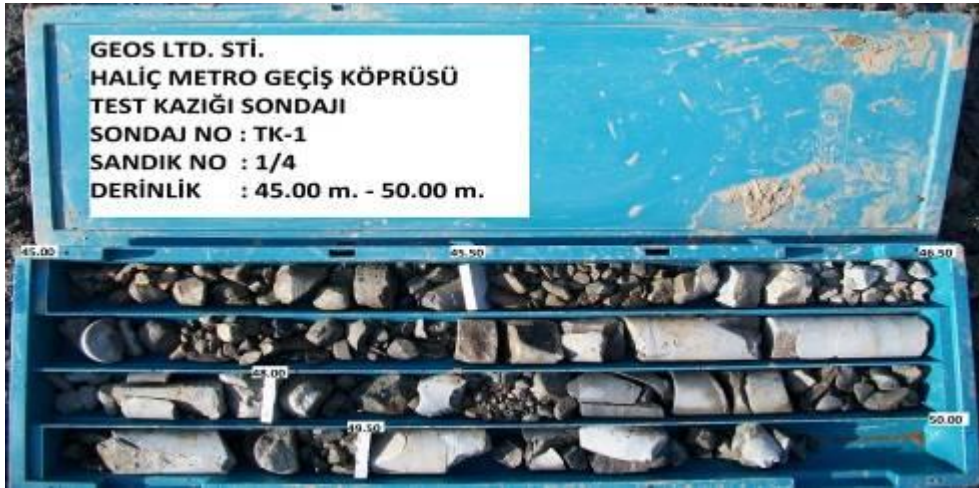
Şekil B-9 : TP2 nolu Osterberg deneyinin yapıldığı noktadaki TK-1 No.lu sondajın karot sandığı fotoğrafları.
