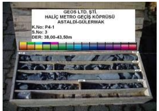
Şekil B-7 : P4-1 ayağı karot sandığı fotoğrafları.
