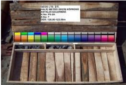
Şekil B-2 : P2-2 ayağı karot sandığı fotoğrafları.
