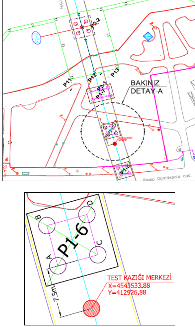
Şekil 6.9 : TP2 no.lu test kazığının lokasyonu.
