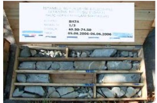
Şekil B-3 : P3-1 ve P3-3 ayakları karot sandığı fotoğrafları (Üstteki 4 fotoğraf; P3-1, alttaki 4 fotoğraf; P3-3'e aittir).
