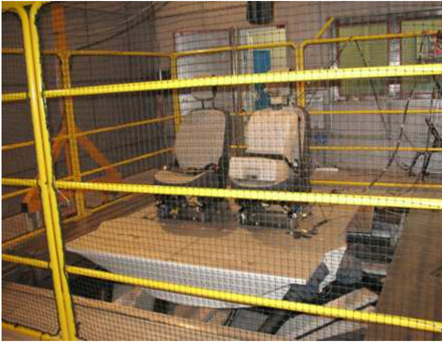
Şekil 3.2 : Çok eksenli sarsıcı üzerine monte edilmiş sürücü ve yolcu koltuğu.
