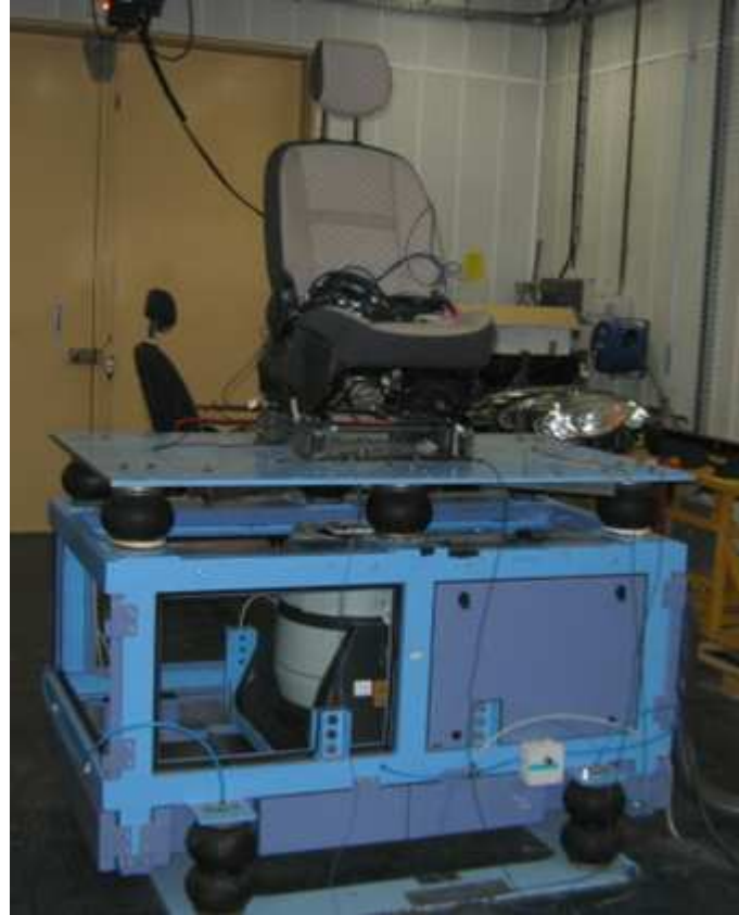
Şekil 3.4 : Tek eksenli sarsıcı üzerine monte edilmiş yolcu koltuğu.
