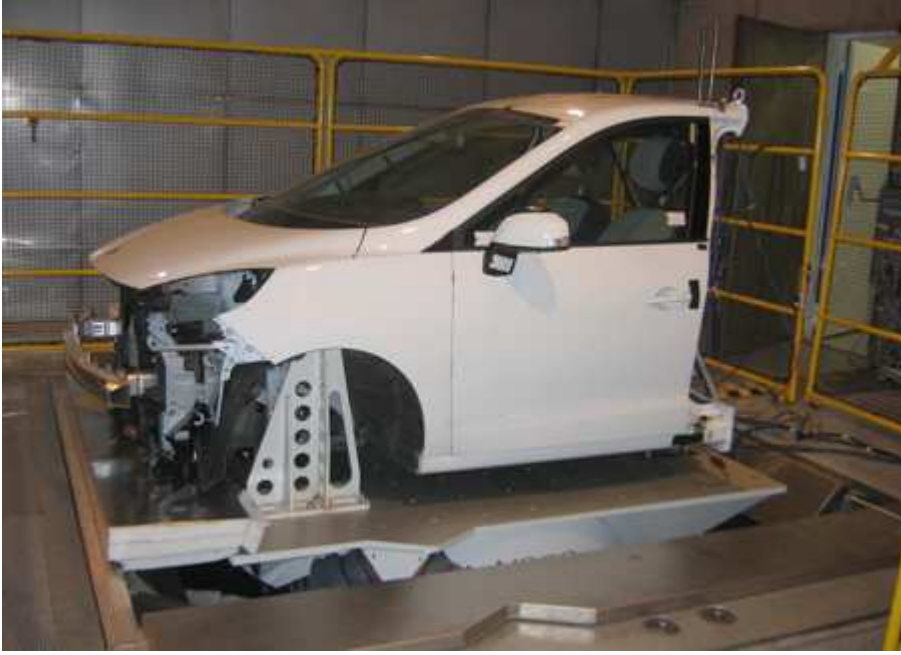
Şekil 3.1 : Çok eksenli sarsıcı üzerine monte edilmiş taşıt ön kabini.
