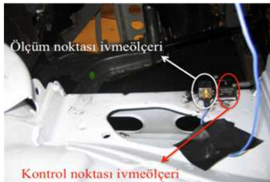
Şekil 3.6 : Ön sağ kiriş ölçüm ve kontrol noktaları ivmeölçerleri.
