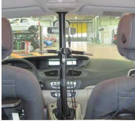
Şekil 3.5 : Mikrofonların kabin içinde yerleşimi.
