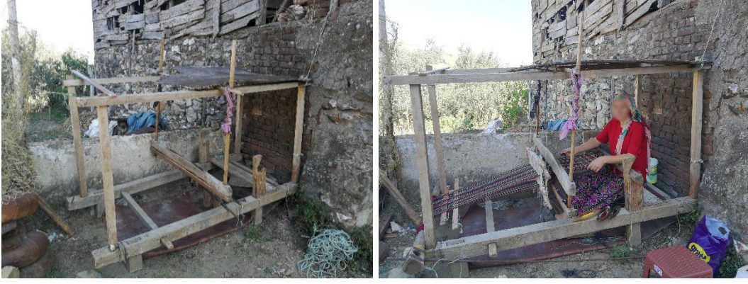
Şekil 6.14 : Bir tezgâhın boşken ve çözgü takıldıktan sonraki hali.
