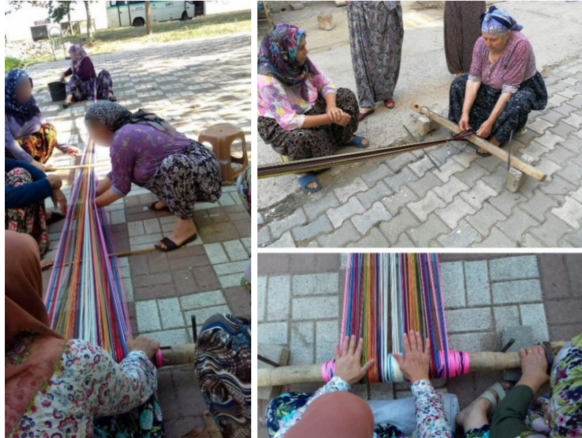
Şekil 6.28 : İplerin tezgâha takılacak alt silindire sarılması.
