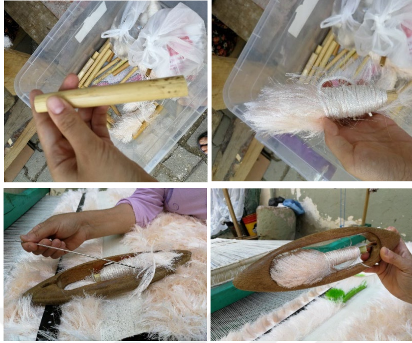
Şekil 6.18 : İpin sarıldığı masur ve mekik.
