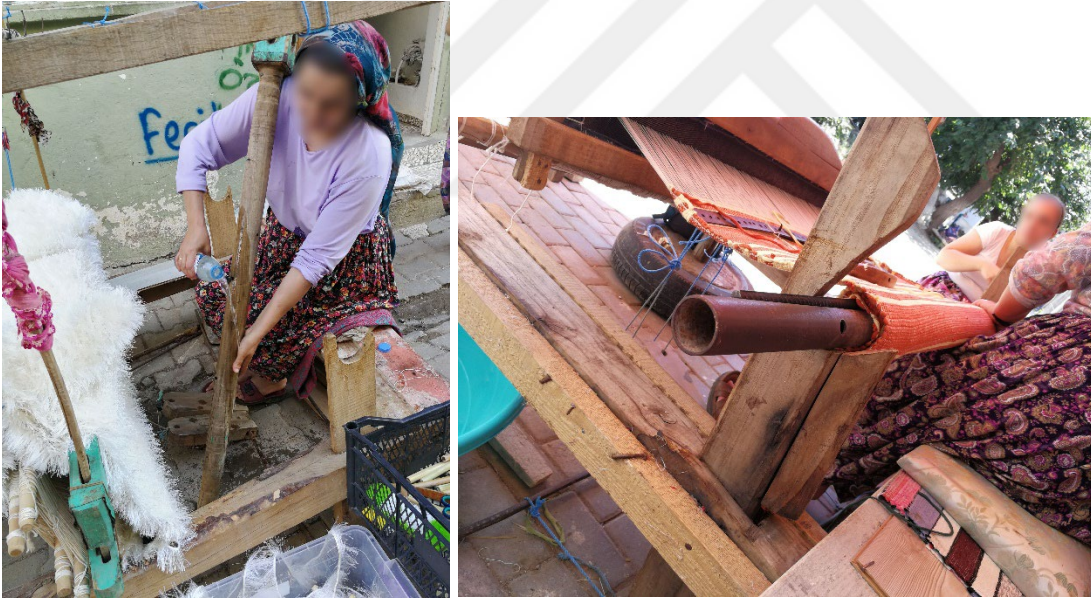
Şekil 6.15 : Ahşap silindir ıslatılırken ve metal silindir örneği.
