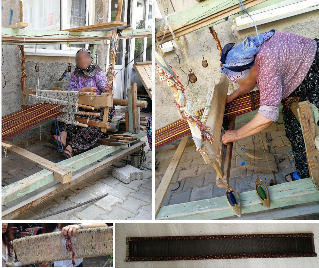
Şekil 6.16 : Pedallar, pedalların bağlı olduğu gücüler, makaralar ve tefenin içine yerleştirilen metal taraklar.
