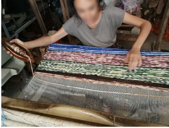
Şekil 6.32 : Argaç çözgünün arasından mekik yardımıyla atılırken ve tefe vurulurken.
