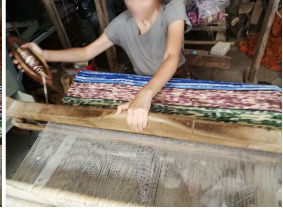
Şekil 6.32 : Argaç çözgünün arasından mekik yardımıyla atılırken ve tefe vurulurken.
