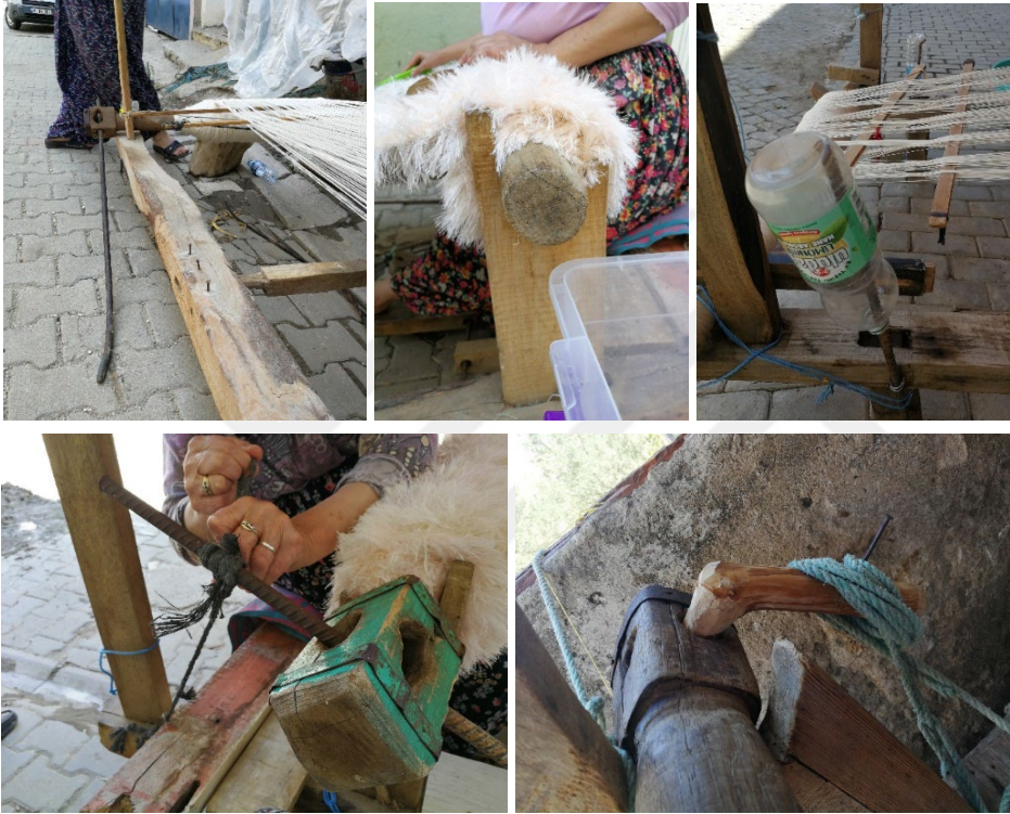
Şekil 6.17 : İpin sarıldığı alt ve dokunan kilimin sarıldığı üst silindirler, onları tutan selmin (demir çubuklar) ve bağlanma şekilleri.
