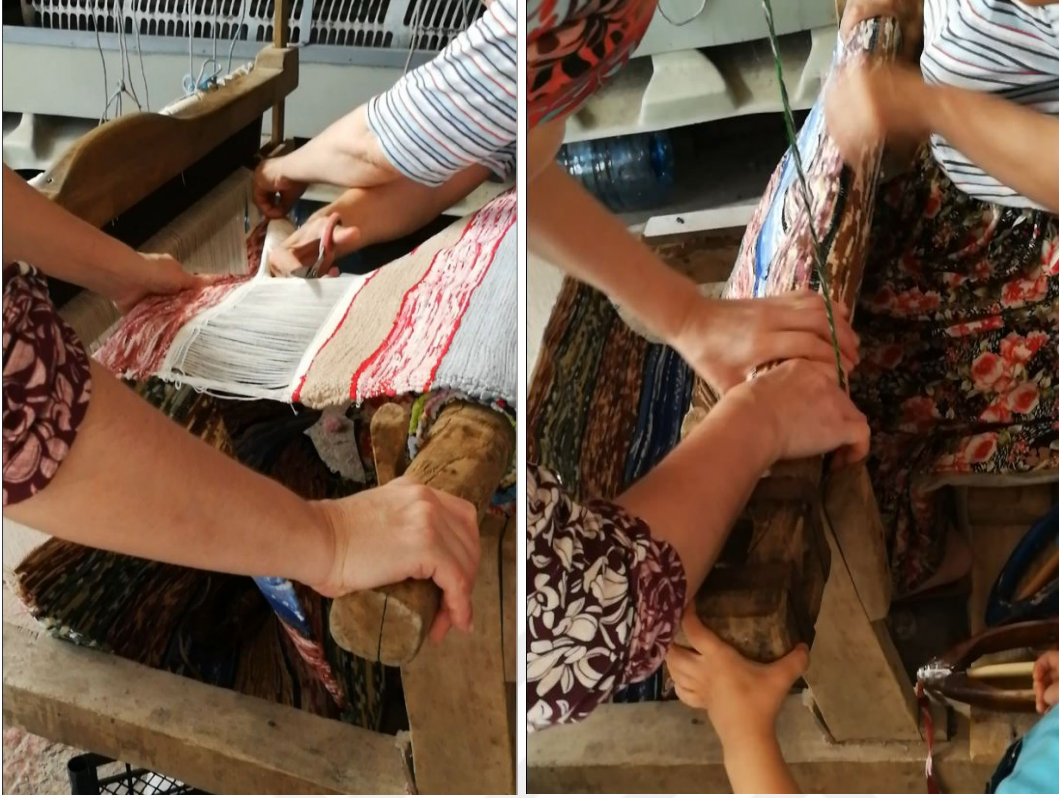
Şekil 6.33 : Dokunan kilimin kesilerek çıkarılması (sol), Kalan kilimin ölçü ipiyle birlikte sarılması (sağ).
