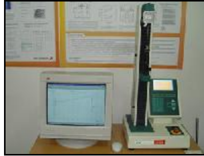
Şekil 4.6 : Sıkıştırma deneyleri için kullanılan Hounsfield H5K-S modelinin genel görünümü.
