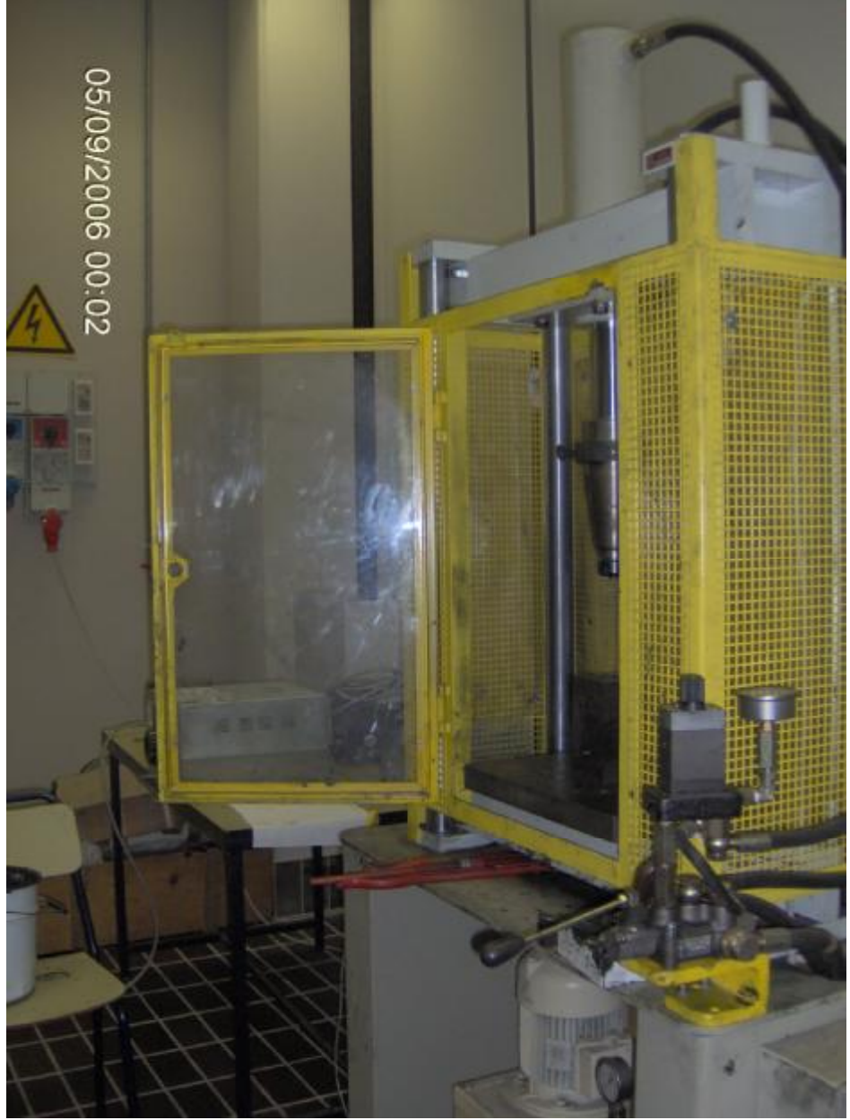
Şekil 6.1 : EKAP testlerinin gerçekleştirildiği pres.
