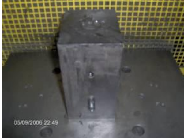
Şekil 6.2 : Testlerde kullanılan EKAP kalıbı.
