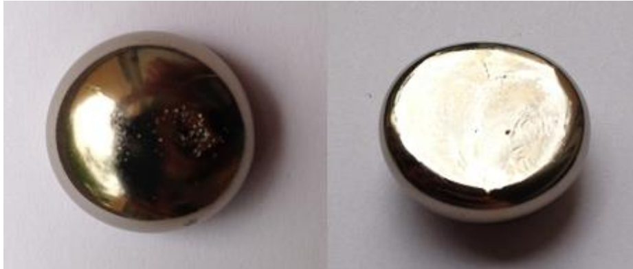
Şekil 6.42 : Elde edilen numune ( Zr_{52.5}Ti_5Cu_{17.9}Ni_{14.6}Al_{10} (%at) alaşımı).
