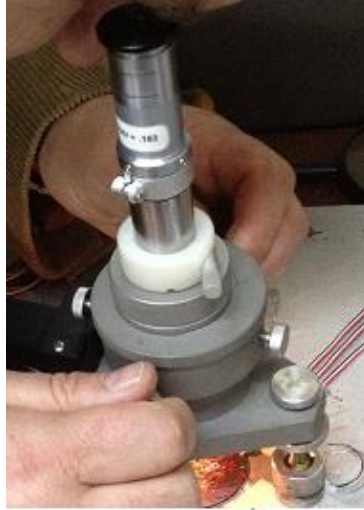
Şekil 6.21 : Mikroskop kullanılarak delinecek deliğin gerinim ölçer merkezine merkezlenmesi.
