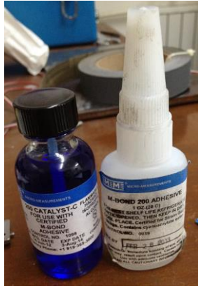
Şekil 6.11 : Gerinim ölçerler için özel olarak üretilmiş M-Bond 200 yapıştırıcı ve katalizör.
