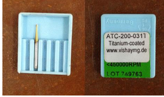
Şekil 6.23 : Deneylerde kullanılan titanyum kaplama 0,8 mm uç çapında kesici uç.
