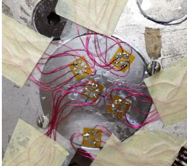
Şekil 6.14 : Tellerin lehimlendiği numune.
