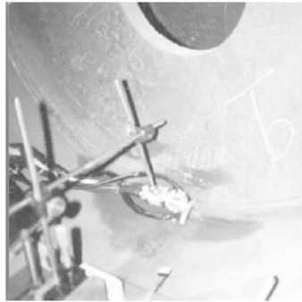
Şekil 5.5 : Petrol sondaj platformunda taşınabilir X-ışını kırınımı ekipmanlarıyla kalıntı gerilme ölçümü [153].
