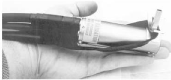
Şekil 5.14 : Minyatür X-ışını kırınımı ölçüm aleti (tek açılı ölçüm yöntemi için) [173].
