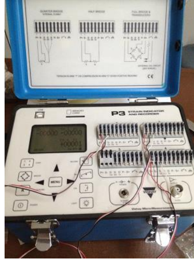
Şekil 6.19 : Gerinim gösterici üzerinde çeyrek Wheatstone köprüsü bağlantısı.
