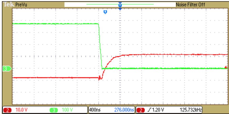
Şekil 5.15 : Çıkış akımı 11 A, D Mosfeti D-S ve kapı gerilimi.
