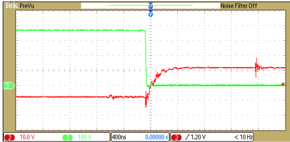
Şekil 5.19 : Çıkış akımı 33 A, D Mosfeti D-S ve kapı gerilimi.
