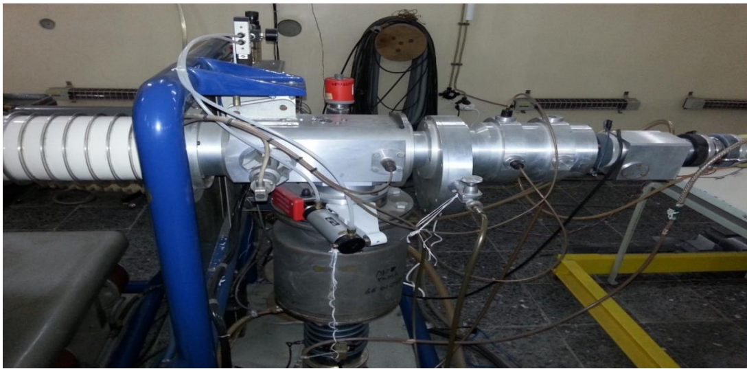
Şekil 5.1 : Sames J-15 hızlandırıcısının ana hızlandırma ünitesi.
