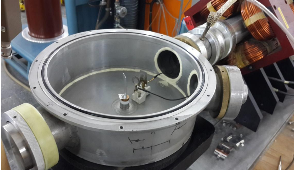
Şekil 5.5 : Reaksiyon odacığının iç görüntüsü. Soldan sağa (hedef, elektron suppresser halkası, üçüncü kolimatör).
