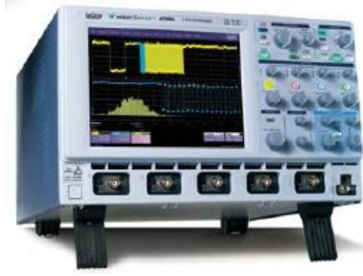
Şekil 3.11 Ölçüm Yapılan Osiloskop (LeCroy LT262 Waverunner2)
