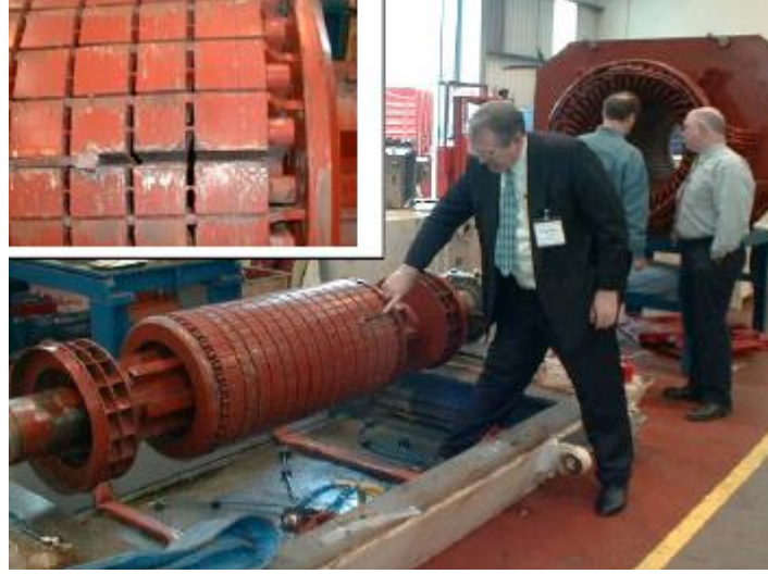
Şekil 2.4 Rotor Çubuk Arızası Meydana Gelen Bir Motor
