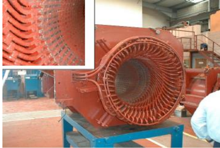
Şekil 2.5 Rotor Çubuğundaki Arızanın Statora Verdiği Zarar
