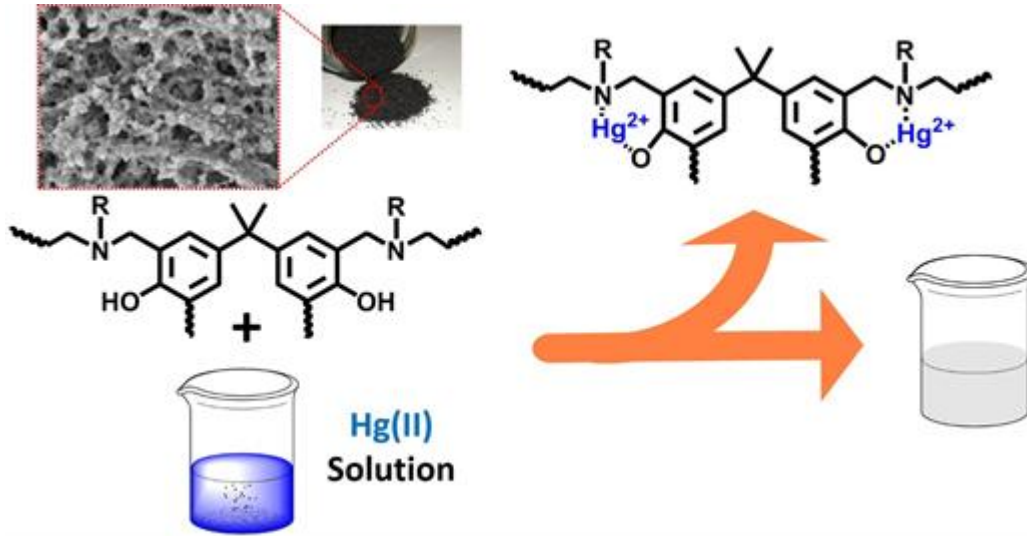
Şekil 1 : Cıvanın uzaklaştırılma mekanizmasının şematik gösterimi.
