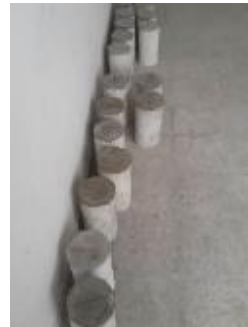
Şekil 2.8 : Silindir numunelere başlık yapılması ve düzeltilmesi
