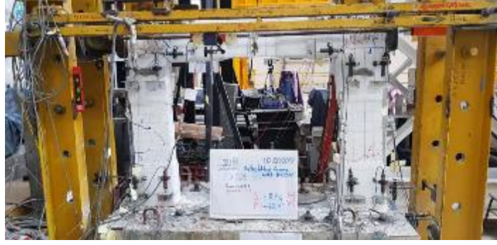
Şekil 4.173 : -18.34 mm Çekme çevrimi doğu cephesi
