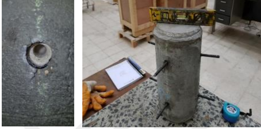
Şekil 2.40 : Numuneye delik açılması ve tijlerin yerleştirilmesi
