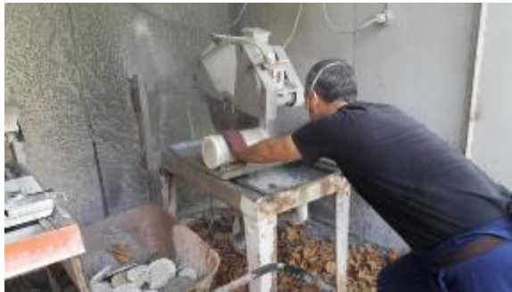
Şekil 2.8 : Silindir numunelere başlık yapılması ve düzeltilmesi
