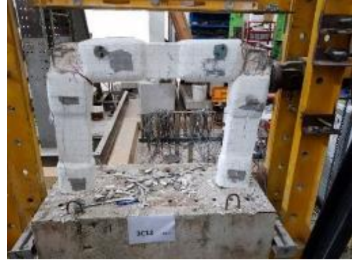
Şekil 4.112 : Numune 6 ileri hasar batı cephesi
