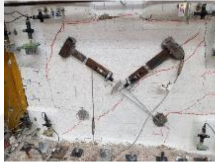
Şekil 4.87 : -9.04 mm çekme çevrimi doğu cephesi
