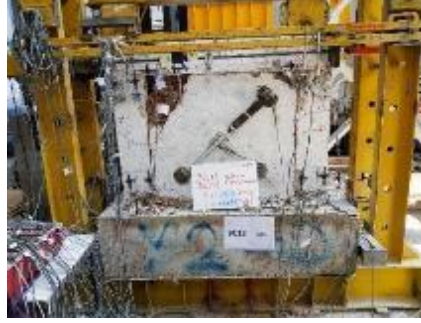
Şekil 4.150 : -28.56 mm çekme çevrimi doğu cephesi
