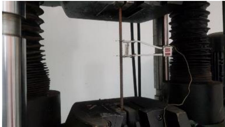
Şekil 2.12 : MTS Deney düzeneği ve donatıya ekstansometre bağlanması
