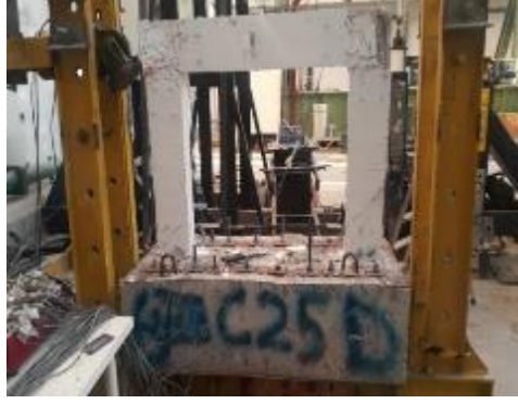
Şekil 4.72 : Numune 4 ileri hasar doğu cephesi
