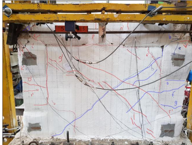
Şekil 4.134 : Numune 7 ileri hasar batı cephesi, kiriş-kolon birleşim bölgesi çekirdek beton ezilmesi, duvarda X kesme çatlağı meydana geldi
