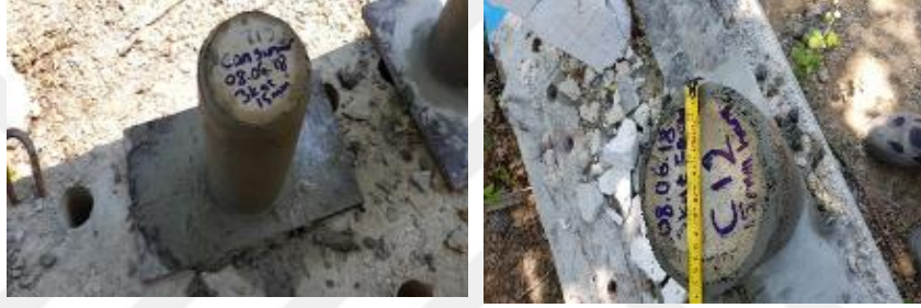
Şekil 2.29 : Silindir Numunesi 3 kat TRM ile sarılarak 15 mm harç kalınlığı yapımı
