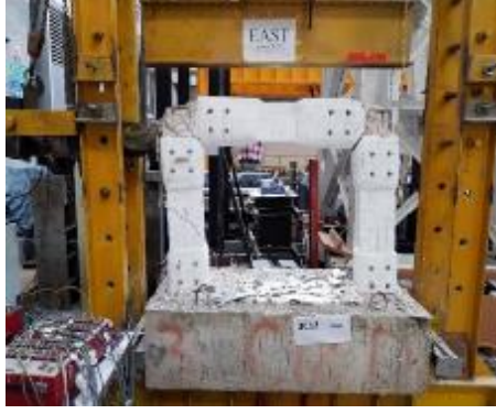
Şekil 4.111 : Numune 6 ileri Hasar doğu cephesi
