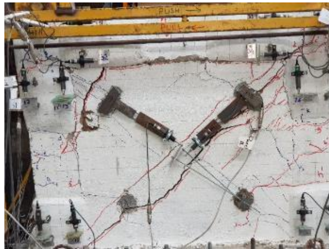
Şekil 4.89 : -13.44 mm çekme çevrimi doğu cephesi
