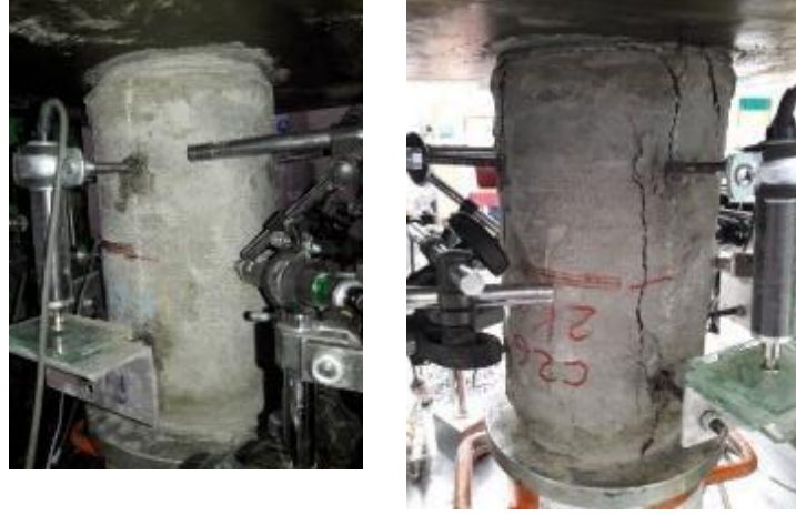
Şekil 2.50 : 2KC26 Numune hasar durumu
