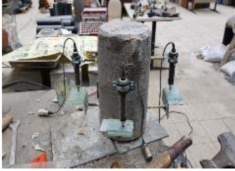
Şekil 2.36 : Düşey şekildegıştırme ölçümü için 90 derece aç konan LVDT CDP 5
