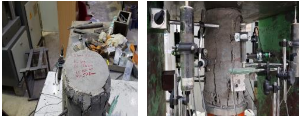
Şekil 2.51 : 3KC26 Numune hasar durumu
