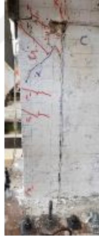
Şekil 4.148 : - 17.94 mm çekme çevrimi batı cephesi
