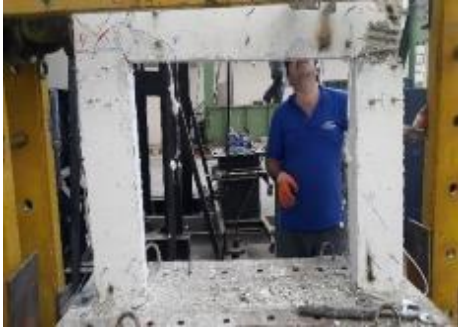
Şekil 4.22 : Numune 1 ileri hasar doğu cephesi
