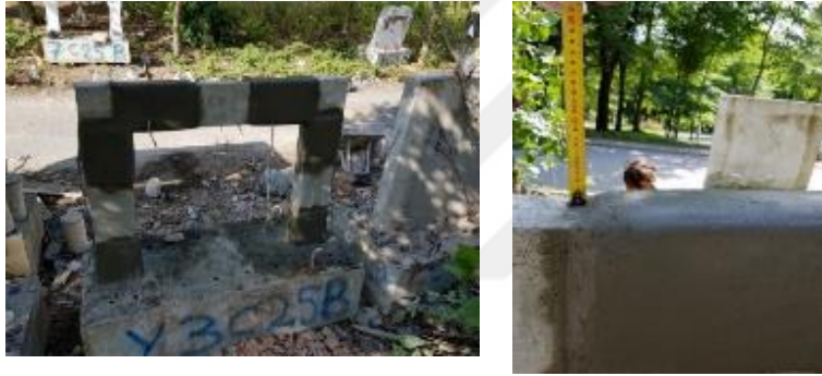
Şekil 2.27 : 3 kat TRM sarılarak güçlendirilmiş çerçevede 15 mm kalınlıkta koruyucu tabaka oluşturulması
