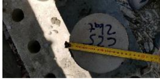
Şekil 2.30 : Silindir Numunesi 2 kat TRM ile sarılarak 10 mm harç kalınlığı yapımı
