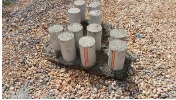
Şekil 2.7 : Beton dökümü sırasında alınan silindir numuneleri
