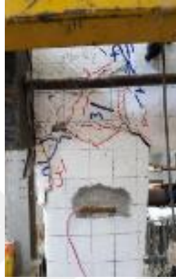
Şekil 4.174 : - 28.50 mm çekme çevrimi batı cephesi
