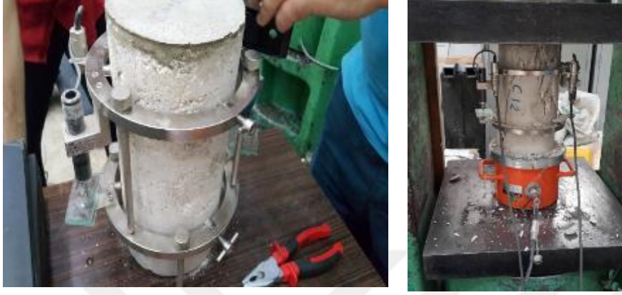
Şekil 2.9 : Deney düzeneği komprasömetre ve standart beton basınç deneyi.
