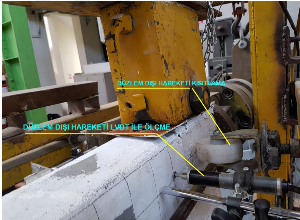
Şekil 3.4 : Numunenin düzlem dışı hareketini ölçme
