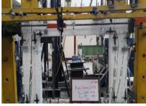
Şekil 4.50 : -28.50 mm çekme çevrimi doğu cephesi
