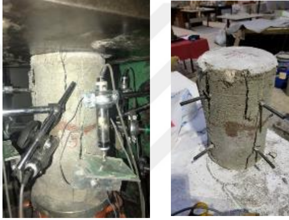
Şekil 2.49 : 1KC26 Numune hasar durumu
