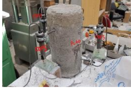
Şekil 2.36 : Düşey şekildegıştırme ölçümü için 90 derece aç konan LVDT CDP 5
