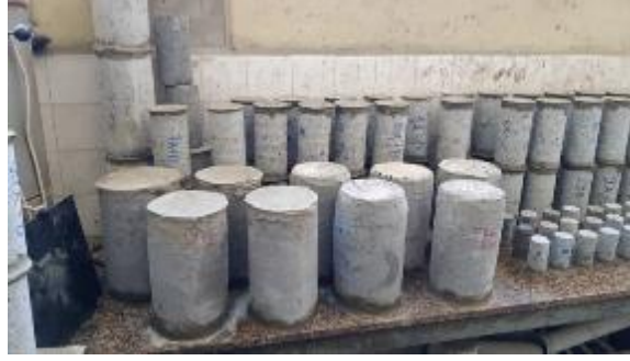
Şekil 2.32 : Farklı tabaka TRM ile sarılmış silindir numunelere başlık yapılması
