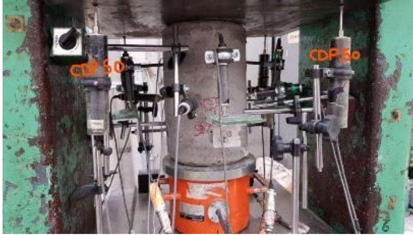
Şekil 2.37 : Başlıklara yerleştirilen 4 adet LVDT CDP 50
