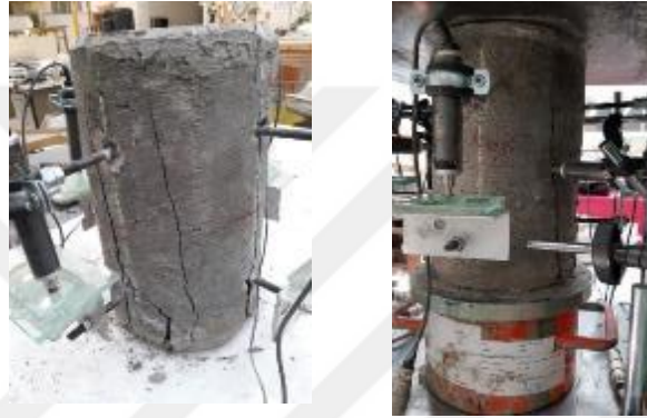
Şekil 2.43 : 1KC15 Numune hasar durumu
