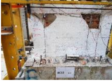
Şekil 4.149 : -22.54 mm çekme çevrimi batı cephesi
