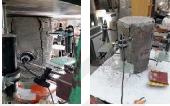
Şekil 2.45 : 2KC15 Numune hasar durumu
