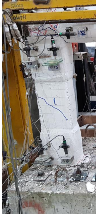
Şekil 4.109 : +29,45 mm itme çevrimi doğu cephesi
