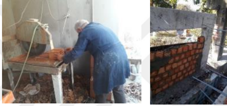
Şekil 2.19 : Tuğlaların deney numunesine uygun olarak kesilmesi ve çerçeve içine duvar örülmesi (Delikler yatay yönde)
