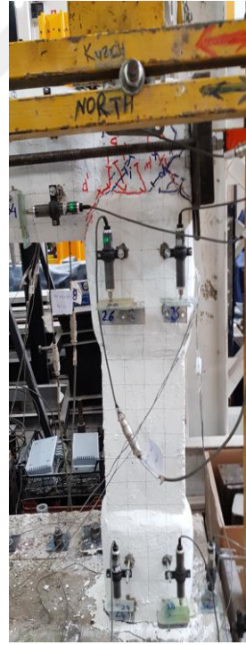
Şekil 4.110 : -28.52 mm çekme çevrimi doğu cephesi
