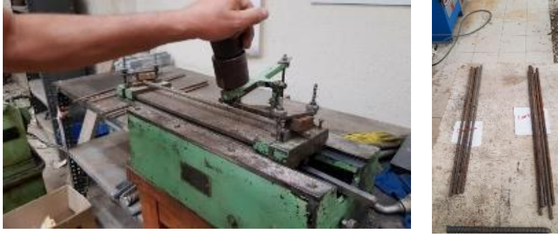
Şekil 2.13 : Nervürlü Donatı numuneleri ve donatıların çizilmesi (çentik izi)
