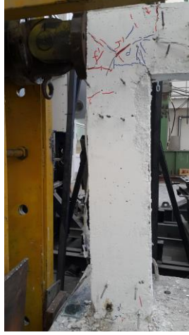
Şekil 4.20 : +43.50 mm itme çevrimi doğu cephesi, ileri hasar
