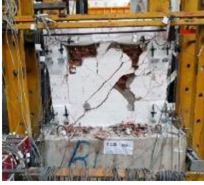
Şekil 4.90 :-22.10 mm çekme çevrimi doğu cephesi
