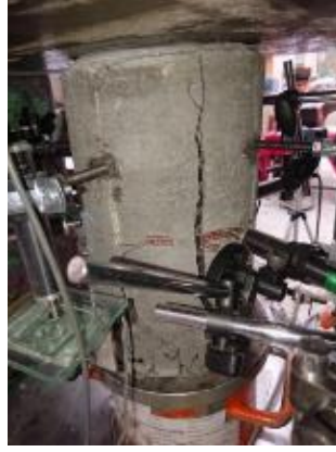
Şekil 2.46 : 3KC15 Numune hasar durumu
