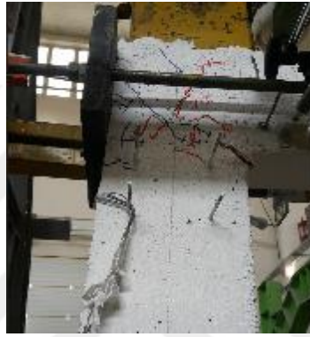
Şekil 4.70 : -43.56 mm çekme çevrimi batı cephesi ileri hasar durumu
