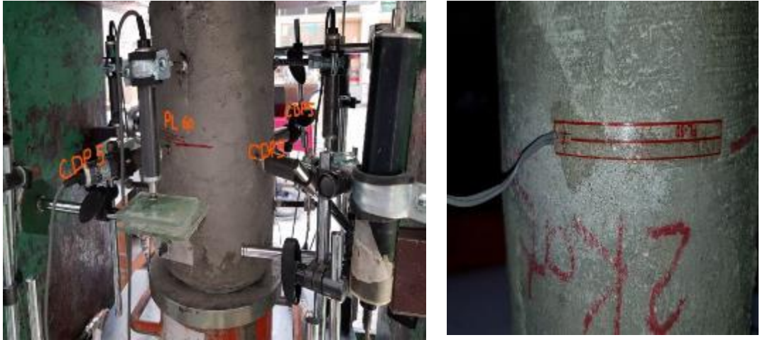
Şekil 2.35 : Enine şekildeğişiklik ölçümü için CDP 5 ve PL60
