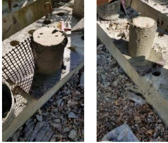
Şekil 2.28 : Silindir numunelere TRM sarılması
