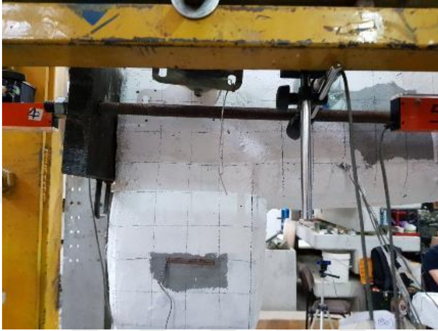
Şekil 4.104 : Şekildeğiştirme ölçer PL60'ın kolon üst ve alt uç bölgelerine yapıştırılması.
