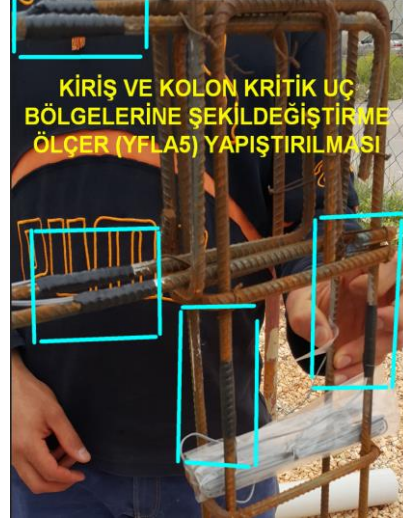
Şekil 2.3 : Şekil değiştirme ölçerlerin (YFLA5) boyuna donatılara yapıştırılması, bantla korunması ve etiketlenilmesi
