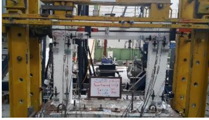
Şekil 4.68 : +43.5 mm itme çevrimi doğu cephesi ileri hasar durumu
