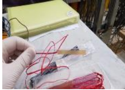
Şekil 4.106 : PL60 şekildeğiştirme ölçer
