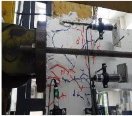
Şekil 4.69 : +43.50 mm itme çevrimi doğu cephesi ileri hasar durumu
