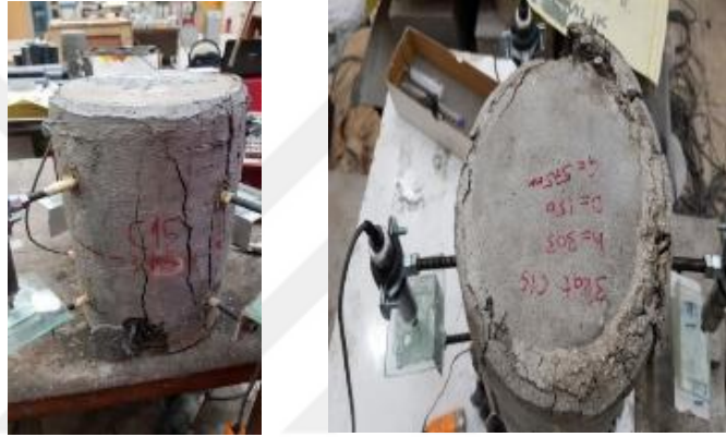
Şekil 2.47 : 3KC15 Numune hasar durumu
