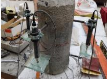
Şekil 2.41 : Numuneye LVDT lerin bağlanması
