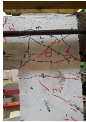
Şekil 4.19 : -28.50 mm çekme çevrimi batı cephesi
