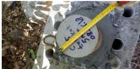
Şekil 2.31 : Silindir Numunesi bir kat TRM ile sarılarak 5 mm harç kalınlığı yapımı
