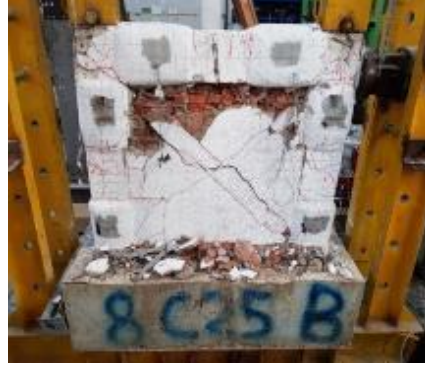
Şekil4.91 : Numune 5 ileri hasar batı cephesi
