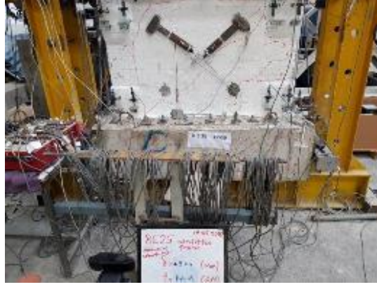
Şekil 4.85 : +9.04 mm itme çevrimi doğu cephesi
