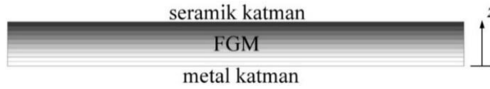
Şekil 1. Fonksiyonel kademelendirilmiş plaka
