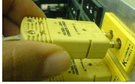
Şekil 3.4 : K tipi termoelemanın erkek ve dişi prizlerinin birleşimi.
