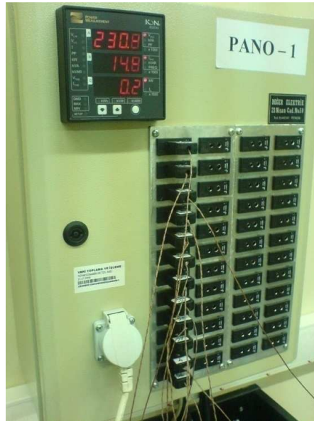
Şekil 3.5 : Pano-1 üzerindeki J tipi termoelemanların dişi prizleri.
