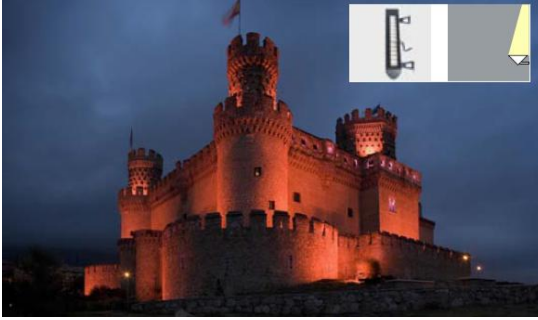
Şekil 2.23 : Lineer LED armatürler ile dış cephe aydınlatması [46].
