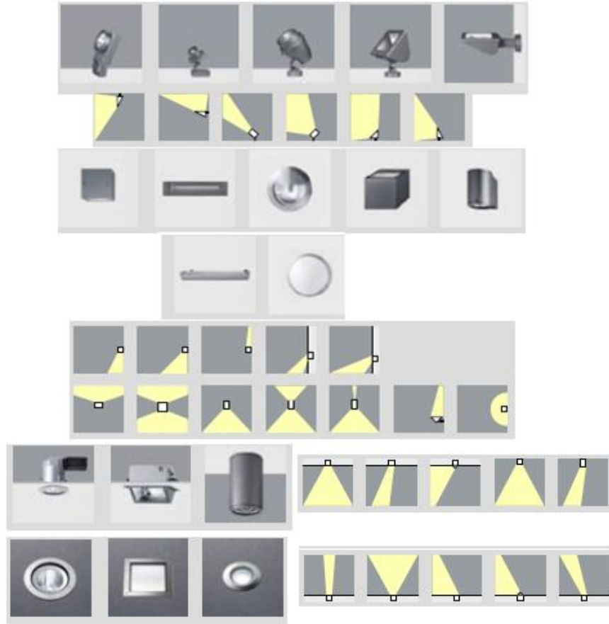
Şekil 2.22 : Farklı açı ve dağılımlarda ışık sağlayan armatür tipleri [46].
