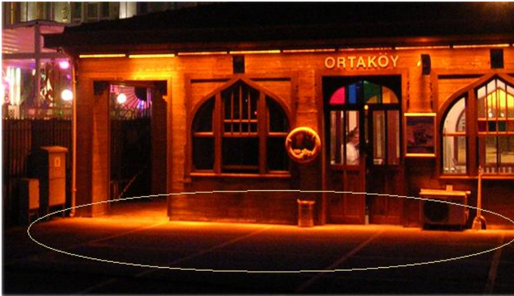
Şekil 4.23 : Işığın istenmeyen yerlere ulaşması sonucu parıltı durumu (Fotoğraf: B. Alişan, 2013).
