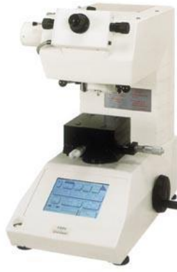
Şekil 5.3 Sertlik ölçümlerinin yapıldığı mikrovickers sertlik ölçüm aleti.
