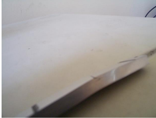
Şekil 6.2 Numunenin yan yüzeyinde delaminasyon başlangıcı.
