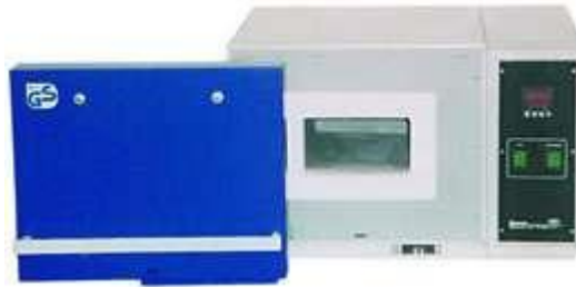
Şekil 5.1 Katı çözeltiye alma işleminde kullanılan PID kontrollü etüv.
