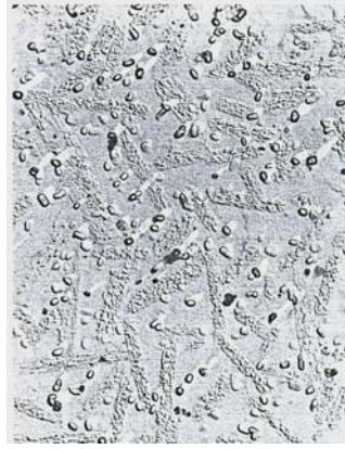
Şekil 3.8: Çok Bileşenli Lityum-Silikat Camında Oluşan Lityum Disilikat Kristalleri [14]
