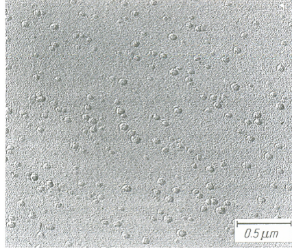
Şekil 4.18: Az Miktarda CaO/P 2 O 5 Eklenmiş Ana Camın Hızlı Soğutulmasından Sonraki Karışmaz Yapı [7]
