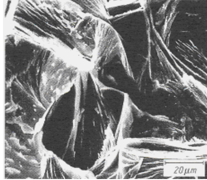
Şekil 4.8: Na 2 O-MgO-Al 2 O 3 -SiO 2 -F Ana Cam Fazında Oluşan Büyük Sodyum Phlogopite Kristalleri [18]
