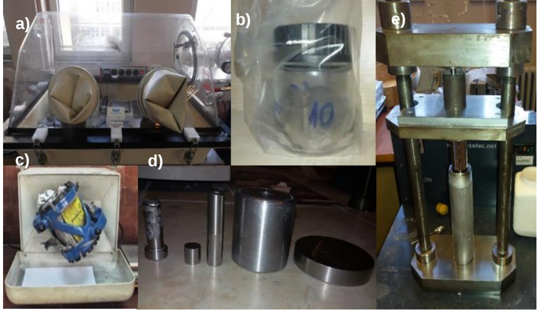
Şekil 4.3 : Numune hazırlamada kullanılan aparatlar. a) vakum eldiven odası, b) cam toz karıştırma kabı, c) turbula mikser, d) pelet kalıbı, e) hidrolik pres.
