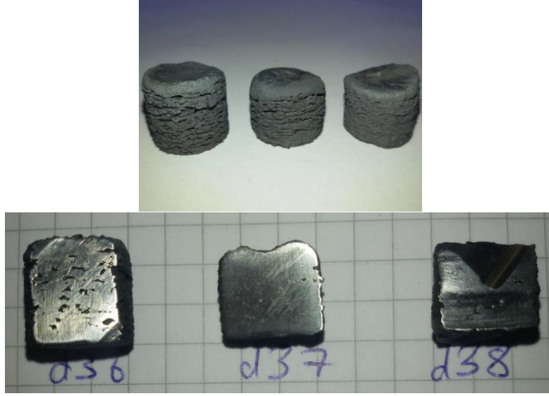
Şekil 4.37 : % 5 Fe içeren sırasıyla 230, 320, 410 °C ön sıcaklıkta sentezlenmiş d36, d37, d38 nolu numuneler ve arayüzeyleri.
