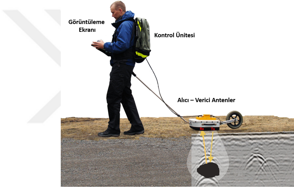
Şekil 2.1 : YNR sistemi ve sistemi oluşturan bileşenlerin gösterimi [1]
