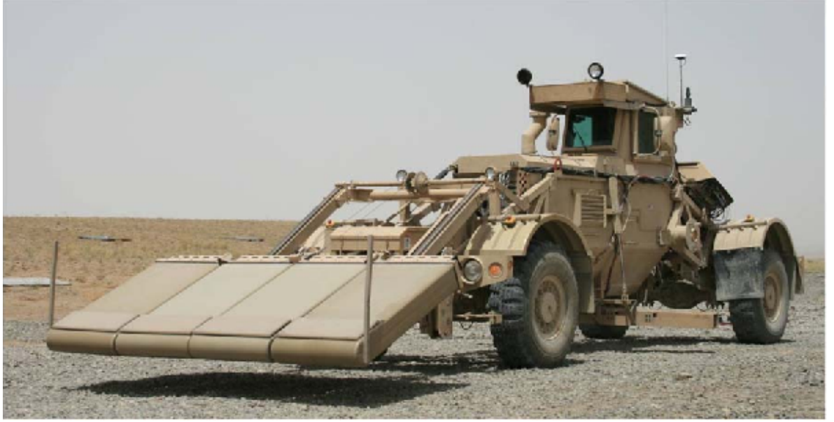
Şekil 2.4 : Araca takılı dizi antenlerden oluşan YNR sistemi [2]
