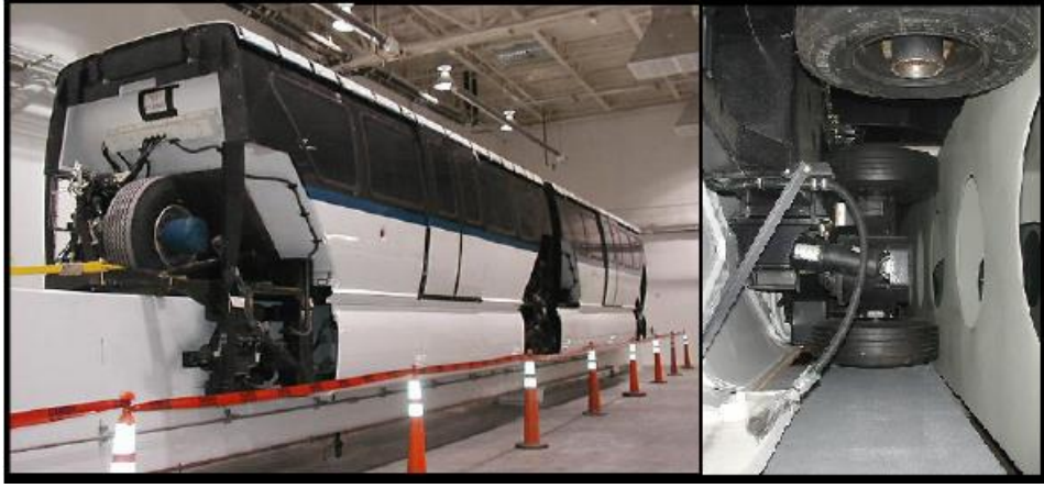
Şekil 3.10: Monorayların taşıyıcı tekerlekleri ve kılavuz tekerlekleri.
