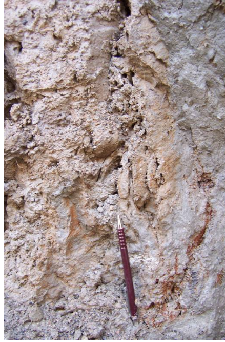
Şekil 5.44 : EKN hendeğinin doğu duvarında gözlenen 1999 İzmit depremine ait kayma düzlemlerinden biri. Kayma çizikleri saf sağ-yanal hareketi göstermektedir.
