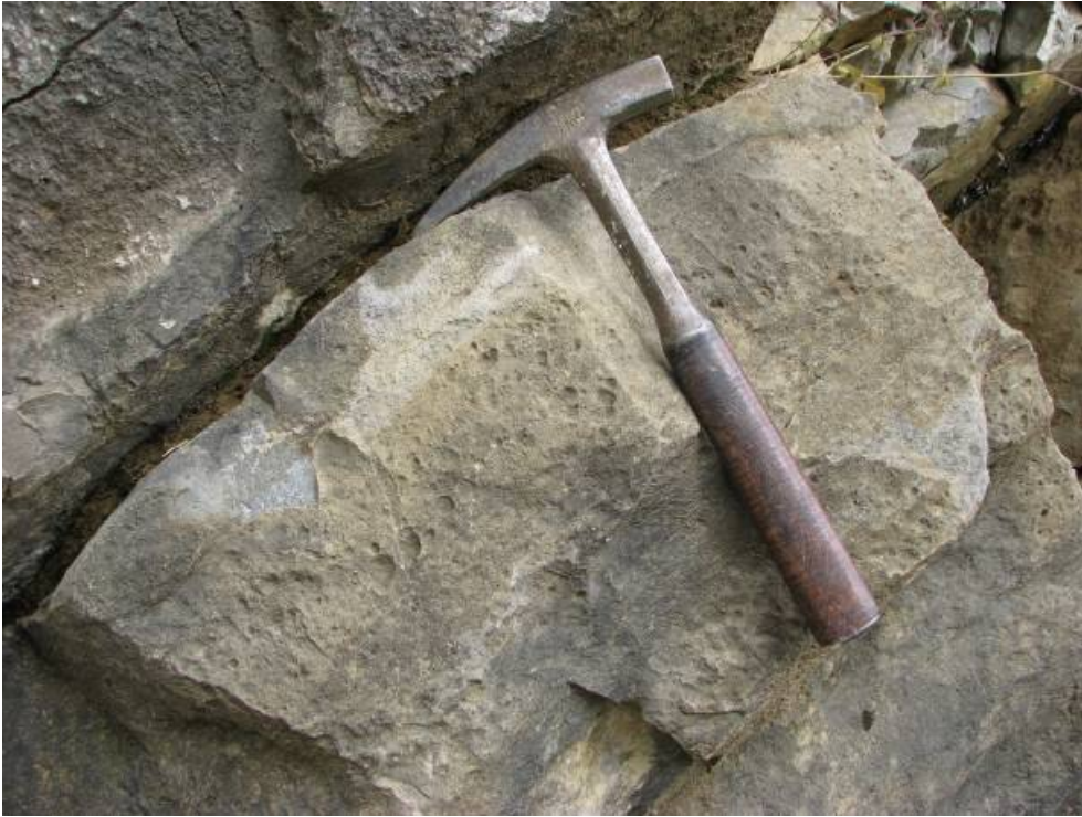
Şekil 3.24 : Derinoba formasyonu içerisinde yer alan Nummulites sp. fosili içeren dayanımlı kireçtaşı seviyeleri.
