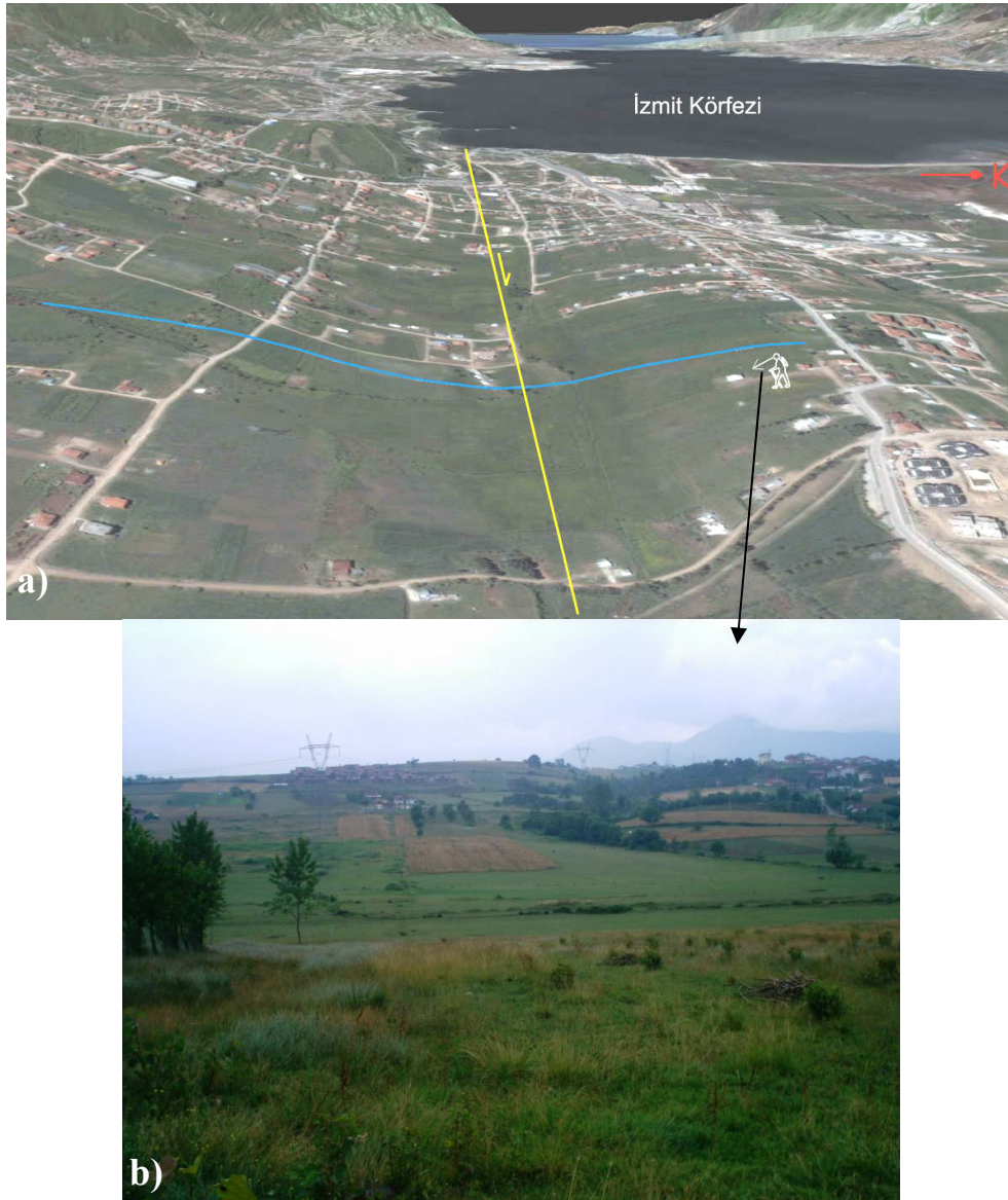
Şekil 4.3 : a) Kullar köyünün yaklaşık 2,5 km güneybatısında, Yüceller mevkiinde 1999 yüzey kırığının izlediği D-B uzanan oluk morfolojisinin batı bakışlı görünümü. Sarı çizgi 1999 İzmit depremi yüzey kırığını, mavi çizgi ise topoğrafik kesiti temsil etmektedir. b) Yüceller mevkiinde, oluk yapısının kuzeyindeki yükseltiden GGB'ya bakışlı fotoğraf.
