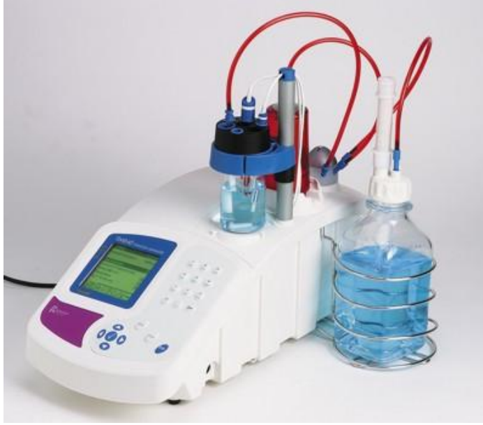
Şekil 3.5 : Eşik klorür konsantrasyonu tayininde kullanılan Titralab 840 cihazı
