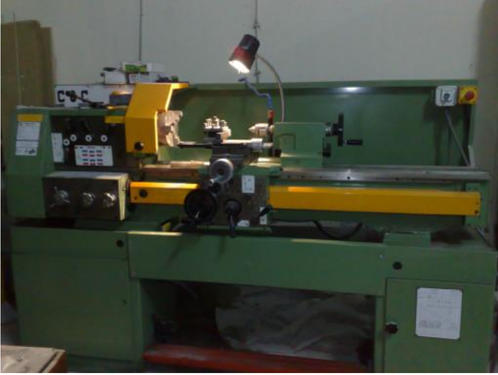
Şekil 3.3 : Toz çıkartma işlemi için kullanılan torna cihazı
