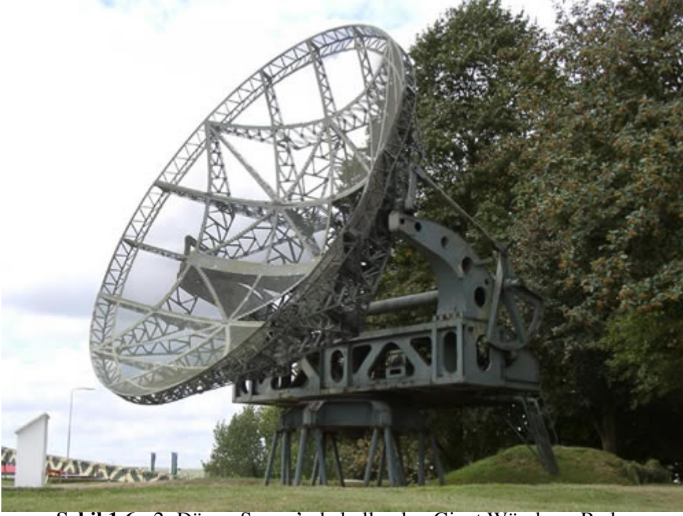
Şekil 1.6 : 2. Dünya Savaşı'nda kullanılan Giant Würzburg Radar
