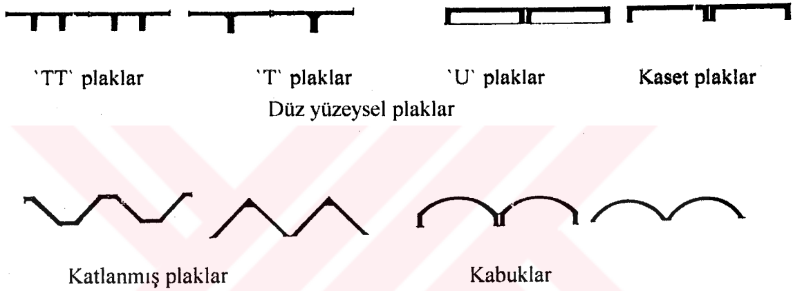
Şekil 6.14. Endüstri binalarında taşıyıcı dış duvar elemanları.[14]
