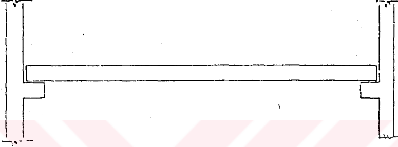
Şekil 3.6. Kirişlerin kolon çıkıntısına oturma durumu[15].
