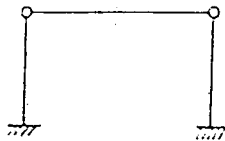
Şekil 3.2. Sabit mafsallı statik sistem
