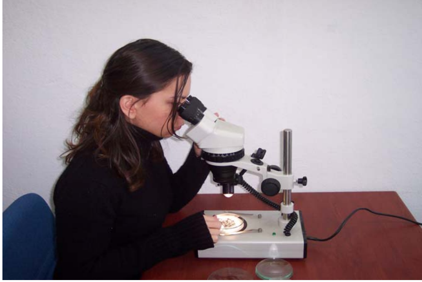
Şekil 2.3: Örneklerdeki sülfürlü minerallerin binoküler mikroskop altında birbirlerinden ayrılması
