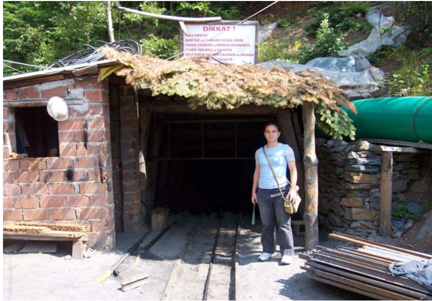
Şekil 4.5: Bağırkaçdere maden ocağı girişi, 150 m’lik bir desandri ile ana galeriye ulaşılmakta
