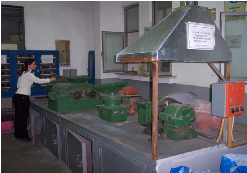
řekil 2.2: rneklerin eneli ve konik kırıcıdan geirilerek ętlmesi.
