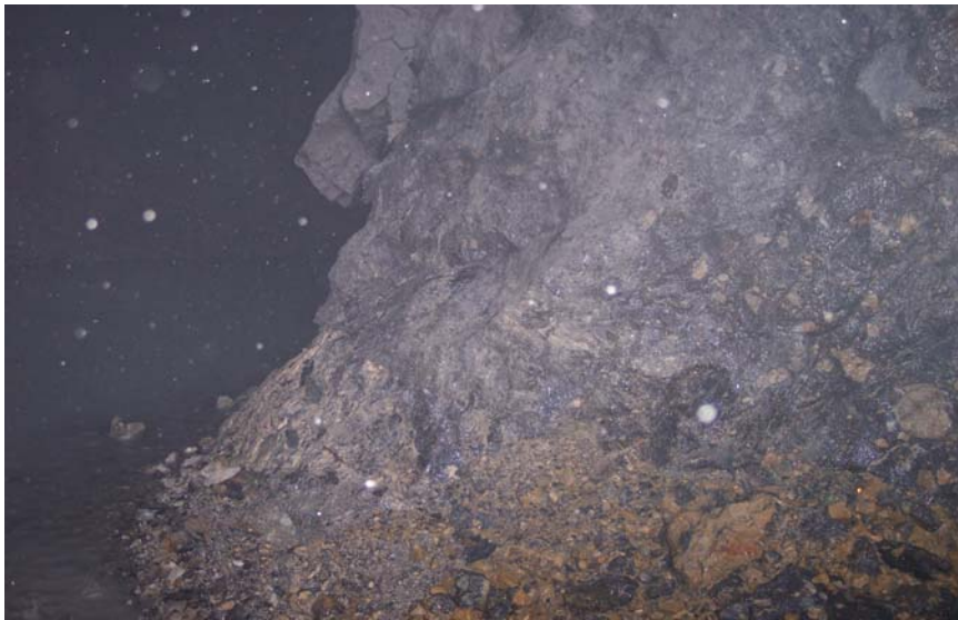
Şekil 4.25: Korudere Madeni (Eskikışla) ocak içi (stokverk tipi cevherleşmeler)
