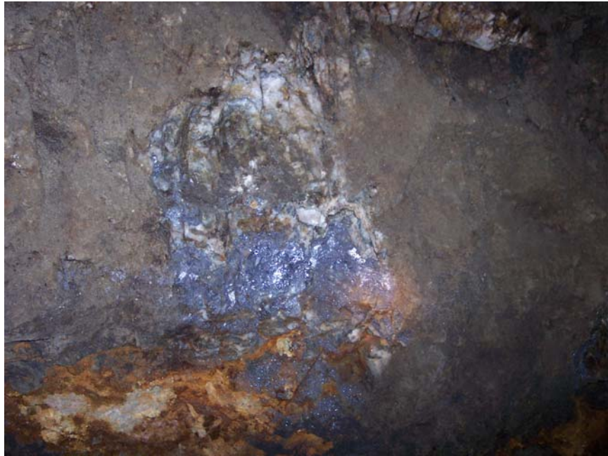
Şekil 4.15: Arapuçandere, 344 kotu, hidrotermal galen oluşumu, kuvars damarı ile birlikte
