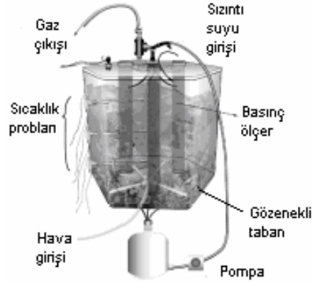
Şekil 3.5: Borling ve diğ., (2004) Tarafından Kullanılan Bioreaktörün Şematik Görünümü
