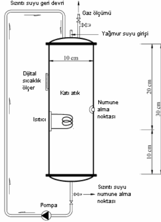
Şekil 3.4: Ağdağ ve Sponza. (2005a, 2005b) ve Ağdağ (2004) Tarafından Kullanılan Bioreaktörün Şematik Görünümü
