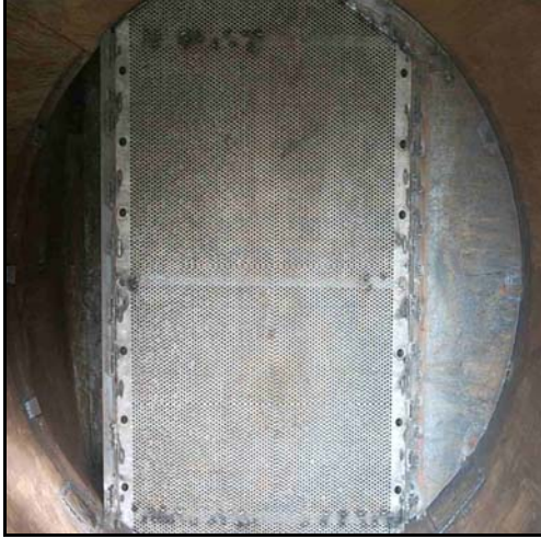
Şekil 4.2: Reaktör Tabanındaki Izgaranın Görünümü
