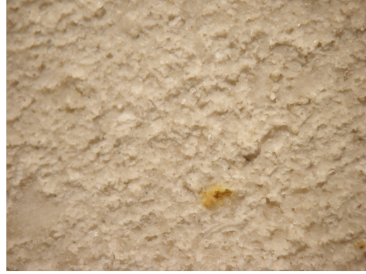
Şekil E.2: Cephede kullanılan kireçtaşı'nın mikroskopik görüntüsü, Baturayoğlu Yöney,2008.
