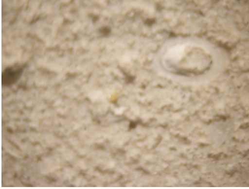
Şekil E.1: Cephede kullanılan kireçtaşı'nın mikroskopik görüntüsü, Baturayoğlu Yöney,2008.
