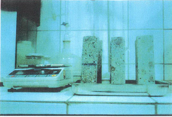
Şekil 3.7 Kılcallık Deneyi Düzeneği
