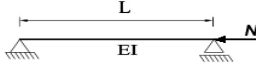
Şekil 3.2 : Eksenel yük etkisinde basit mesnetli çubuk
