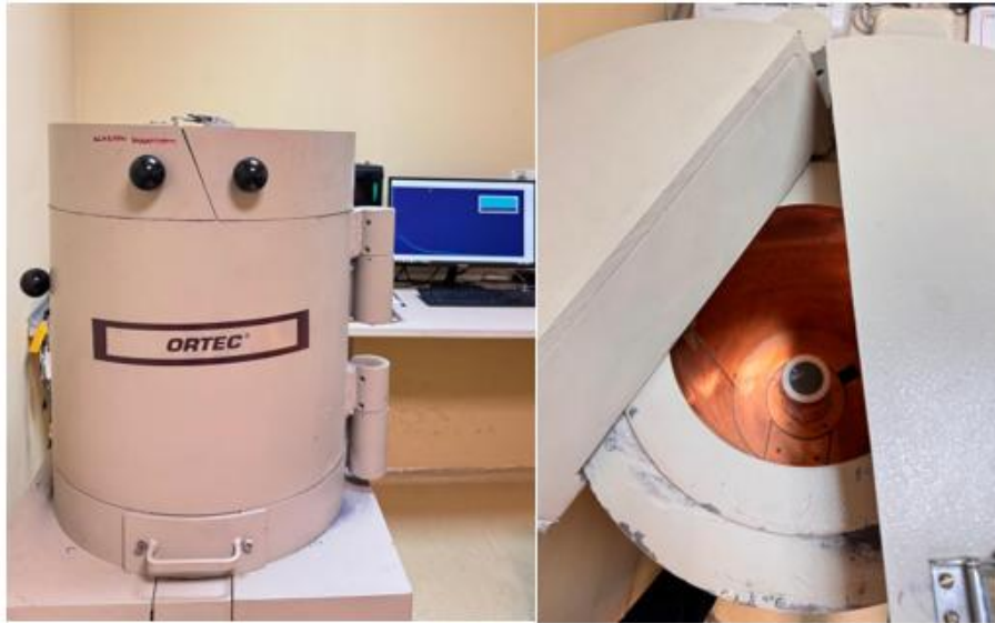
Şekil 3.4 : İstanbul Teknik Üniversitesi Enerji Enstitüsü Düşük Seviyeli Radyoaktivite Ölçümleri Laboratuvarı'nda bulunan p-tipi eş eksenli HPGe dedektörlü gama spektrometresi.
