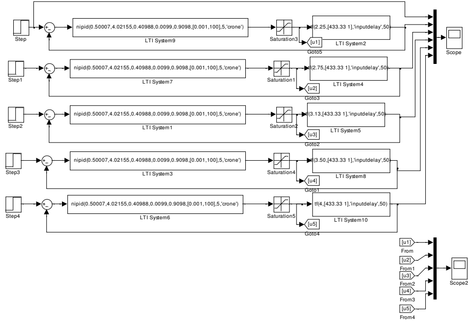
Şekil 5.1 : K = 2.25, 2.75, 3.13, 3.50, 4 değerleri için oluşturulan sistemin kapalı çevrim blok diyagramı.
