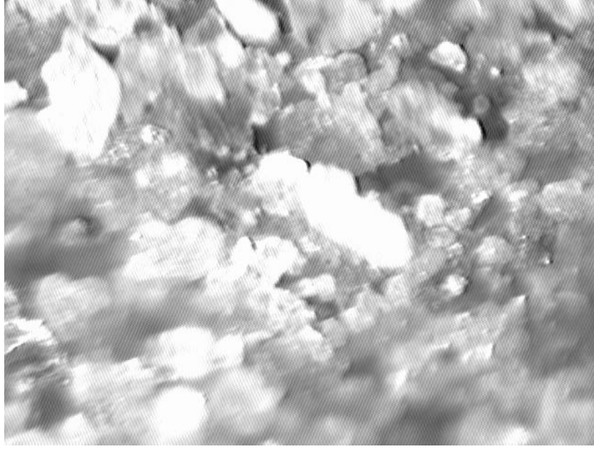
Şekil 5.3 Dinamik deney sonrası örselenmemiş Adapazarı numunesi yatay kesit görüntüsü ( X150 , \tau_d/\sigma_c'=0.327 , \sigma_c=100 kPa)
