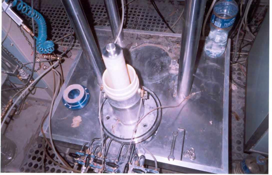
Şekil 3.8 Dış kalıba vakum uygulayarak membranı gergin tutma
