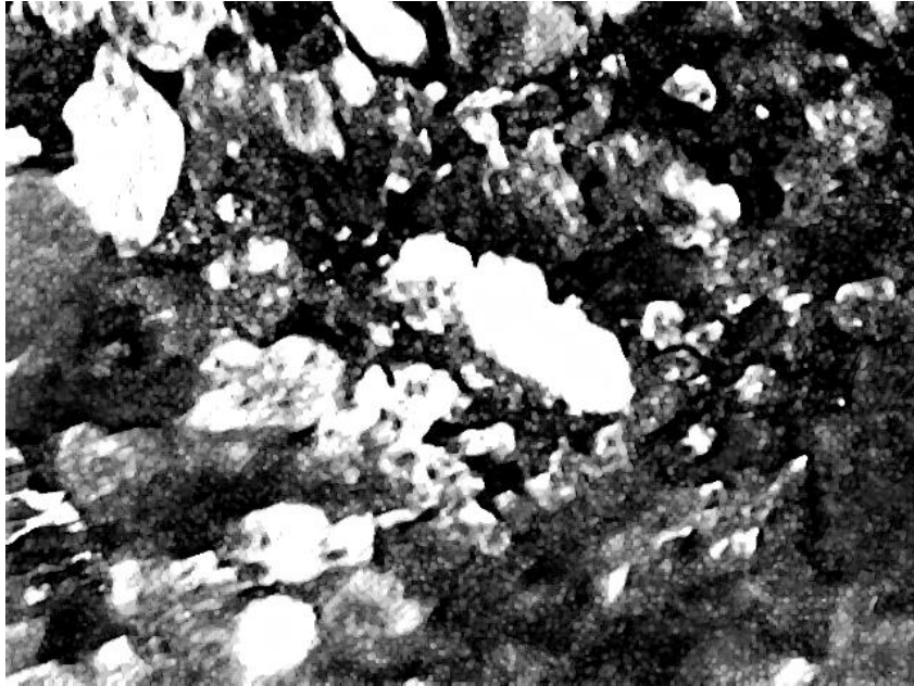
Şekil 5.4 Örselenmemiş Adapazarı numunesi yatay kesit işlem sonrası görüntü ( X150 , yatay: 1.00 mm, düşey: 0.75 mm)
