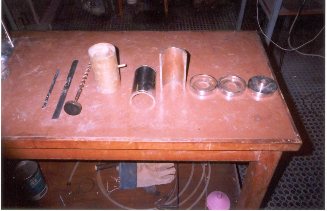
Şekil 3.13 Örselenmemiş numunenin orta kısmının oyulmasında kullanılan aletler
