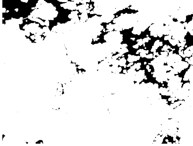
Şekil 5.15 Şekil 5.14'deki mikrografiğe ait siyahla görülen boşluklu bölgeler (X150)
