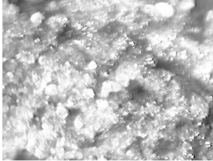
Şekil 5.31 Konsolidasyon ve tekrarlı yükleme sonrası Adapazarı örselenmemiş numunesi yatay kesit X-düzleminde alınan görüntü (X150, yatay: 1 mm, dikey 0.75 mm)
