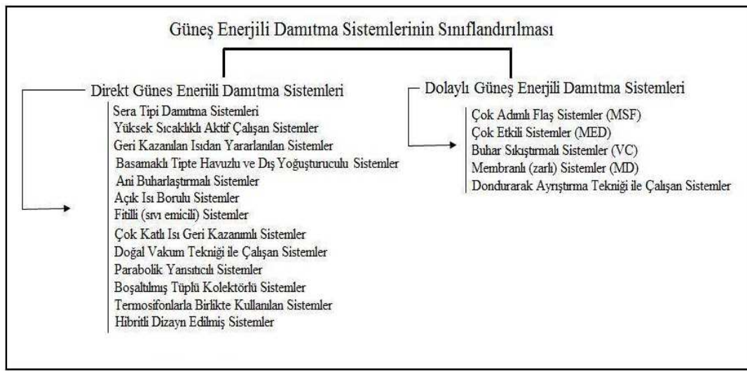
Şekil 3.1 : Güneş enerjili damıtma sistemlerinin sınıflandırılması.
