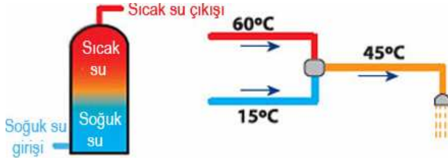
Şekil 3.24 : Kapalı devreli doğal dolaşımli bir sisteme örnek (Url-2, 2010).
