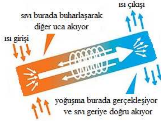
Şekil 3.8 : Açık ısı borulu damıtma sistemi ısı borusu çalışma prensibi (Url-2, 2010).
