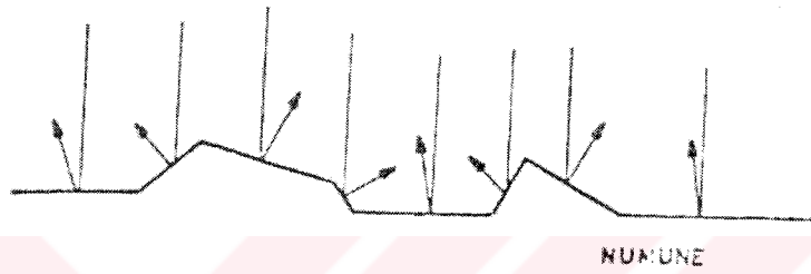
Şekil 2.3.2.2. Gerisaçılan elektronların yüzey ayrıntılarından değişik yönde çıkışları. [24]
