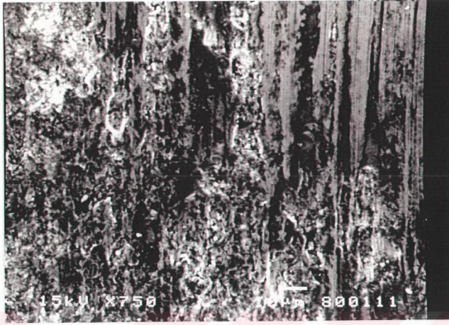
Şekil A.19: TiN kaplamaya karşı çalışmış ferritik paslanmaz çelik karşı malzemede kazımalı aşınma sonrası yüzeyin genel görüntü (1.5N normal yük-10Hz frekans).
