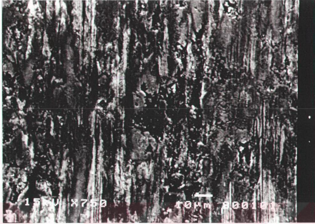
Şekil A.13: TiN kaplamaya karşı çalışmış ferritik paslanmaz çelik karşı malzemede kazımalı aşınma sonrası yüzeyin genel görüntü (1.5N normal yük-5Hz frekans).
