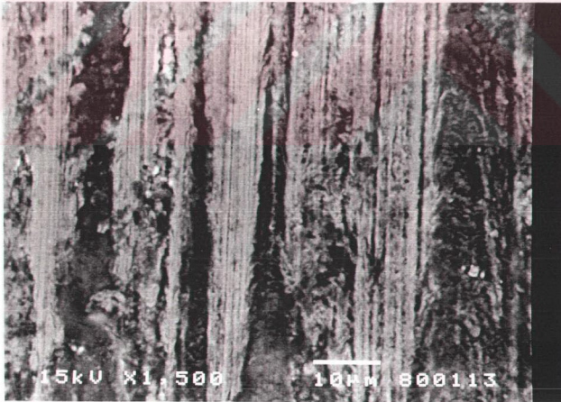
Şekil A.20: TiN kaplamaya karşı çalışmış ferritik paslanmaz çelik karşı malzemenin detay görüntüsü. Açık renkli bölge: 83.28Fe-15.99Cr-0.73Si (% Ağ.), koyu renkli bölge: 83.42Fe-15.85Cr-0.73Si (% Ağ.) (1.5N normal yük-10Hz frekans).
