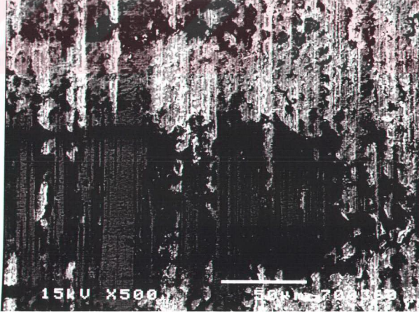
Şekil A.30: TiN kaplamalı yüksek hız takım çeliğinin aşınmış yüzeyinin detay görüntüsü.
