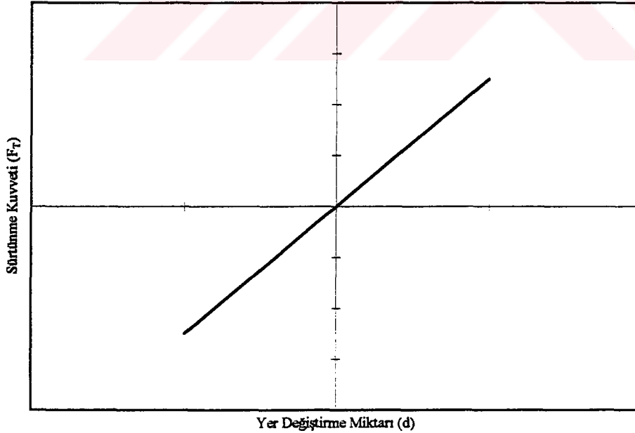
Şekil 5.17: Elastik yapışma koşullarında elde edilen dinamik sürtünme kuvveti-yer değiştirme miktarı eğrisi[41-45].
