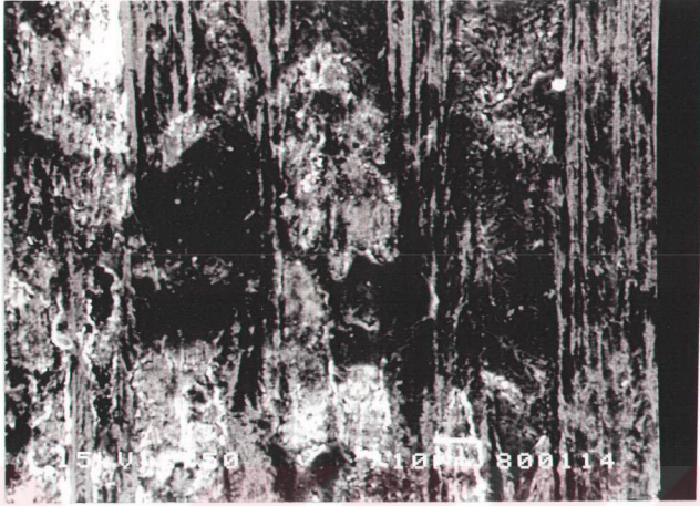
Şekil A.21: TiN kaplamaya karşı çalışmış ferritik paslanmaz çelik karşı malzemedeki kazımalı aşınma sonrası yüzeyin genel görüntü (2N normal yük-10Hz frekans).
