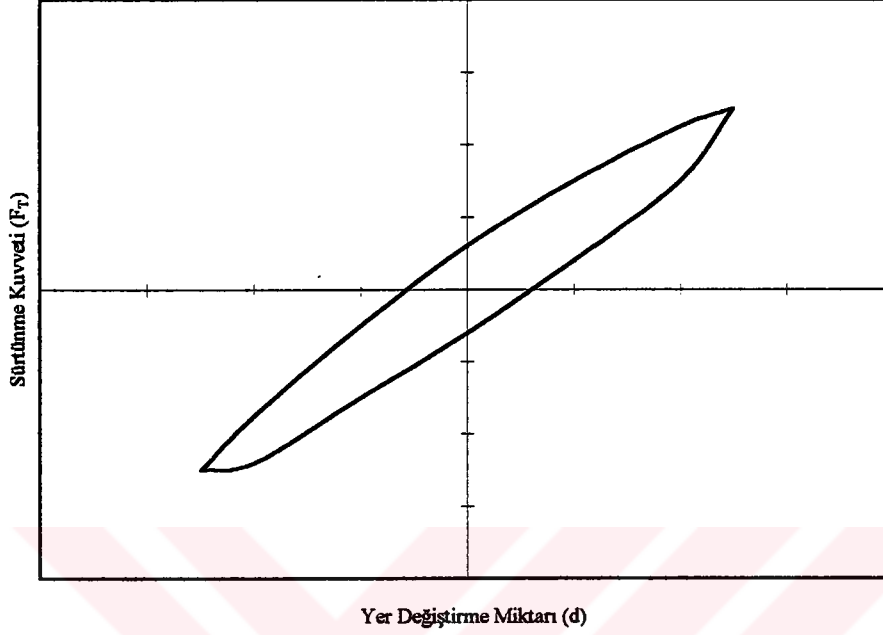
Şekil 5.18: Kısmi kayma koşullarında elde edilen dinamik sürtünme kuvveti-yer değiştirme miktarı eğrisi[40-47].
