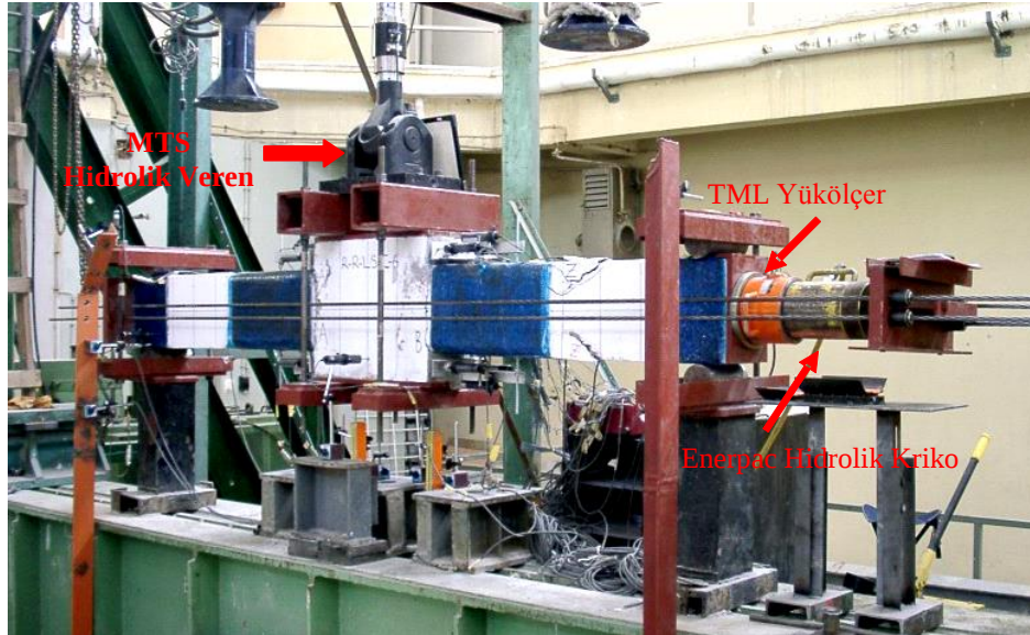
Şekil 4.1. Numune ve Yükleme Sisteminin Genel Görünümü
