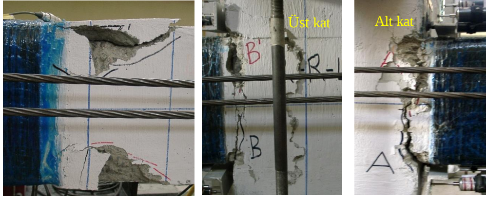
Şekil 5.38. Numunenin \mu=3.5/2 Değerine Aderans Çatlakları ve \mu=4.5/2 Değerinde Üst ve Alt Kat Kolon-Kiriş Birleşim Kesitleri
