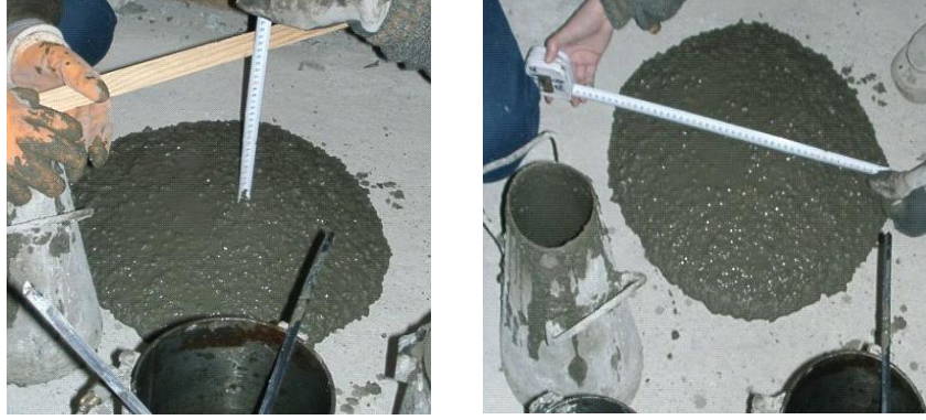
Şekil 3.19. Taze Betonda Çökme ve Yayılma Çapı Ölçülmesi
