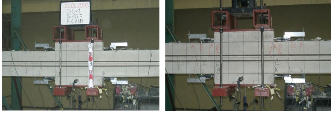
Şekil 5.1. Numunenin Öteleme Oranı=%0.25’de ve Öteleme Oranı=%0.6’da (akma yerdeğiştirmesine ulaşmadan önce) Genel Görüntüsü
