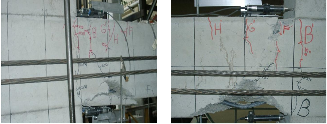
Şekil 5.2. Yerdeğiştirme Sünekliğinin -2 değerinde ( \delta=-19 mm) Yapılan İlk veİkinci Çekme Sonrası Genel Görüntü
