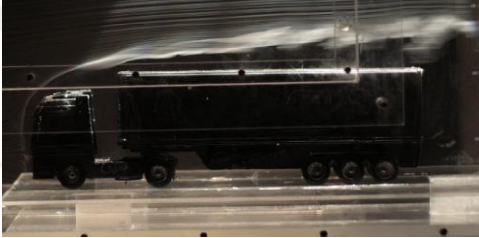
Şekil 1.4: Rüzgar tüneline kamyon modelinin etrafındaki akış görüntüsü [9].
