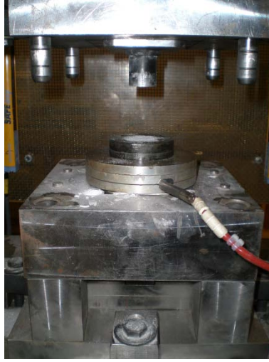
Şekil 5.2. Alüminyum köpük üretiminde kullanılan ısıtıcılı kalıp.
