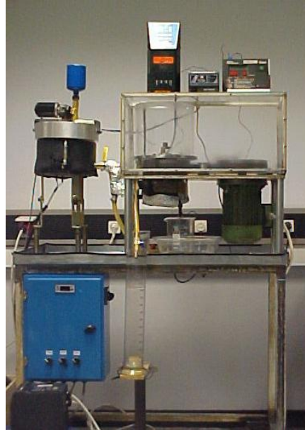
Şekil 4.1 : Yağlama sistemi yağ debisini etkileyen faktörlerin incelendiğı düzenek
