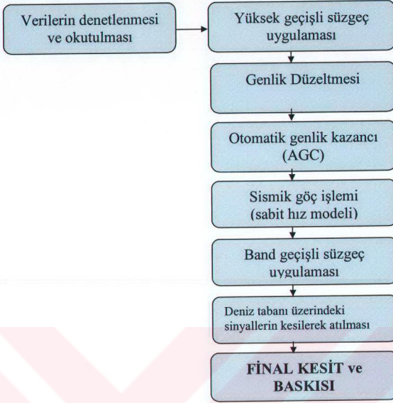
Şekil 3.43 Tek-kanallı verilere uygulanan veri-işlem yöntemlerini gösteren akış şeması.
