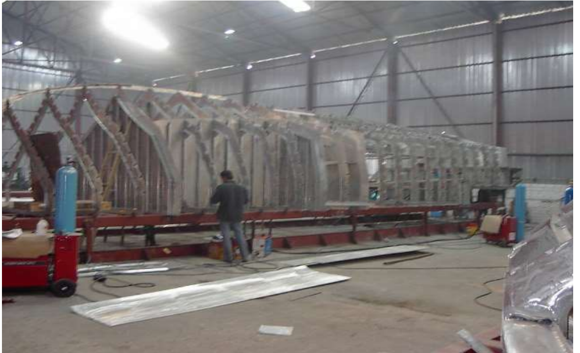
Şekil 4 6 : İnşaat halindeki Alüminyum teknenin ters çevrilmiş şekilde görünüşü
