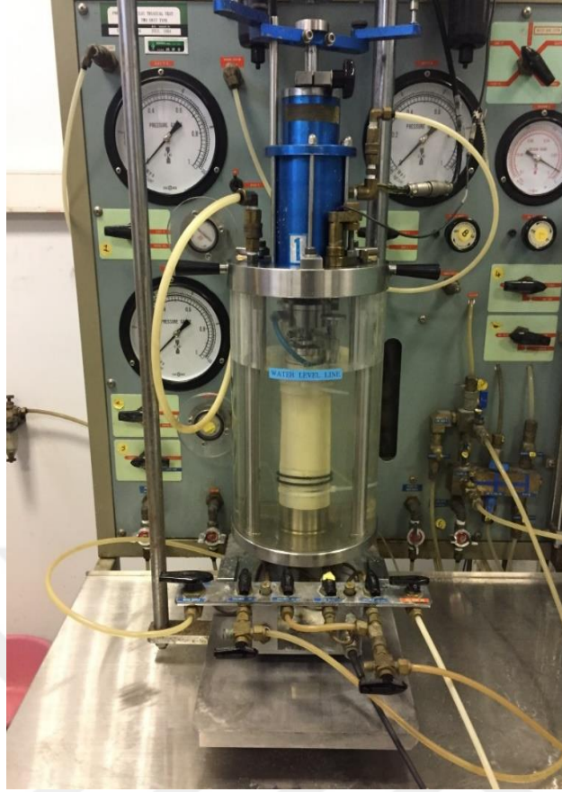
Şekil 5. 12 : Dinamik üç eksenli deney aletinde kum numunenin çevre basıncı yardımıyla ayakta tutulması.
