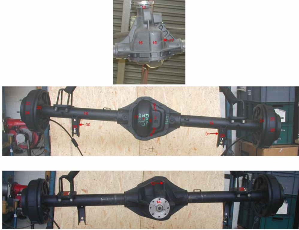
Şekil 4.6. Arka aks deneysel Frekans Karakteristik Analizi darbe noktaları
