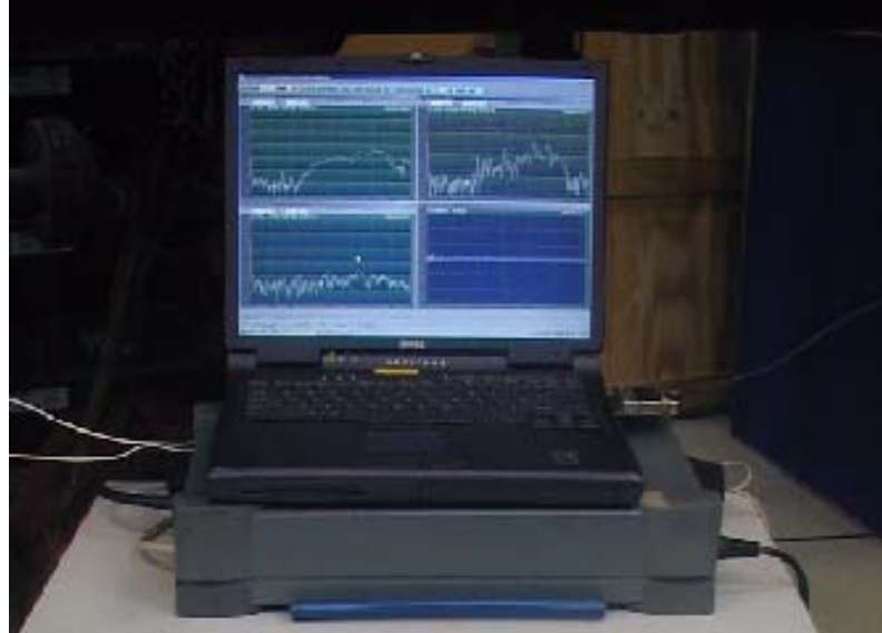
Şekil 3.4. Verilerin işlenmesi (OROS 25) FFT analizörü ve dizüstü bilgisayar
