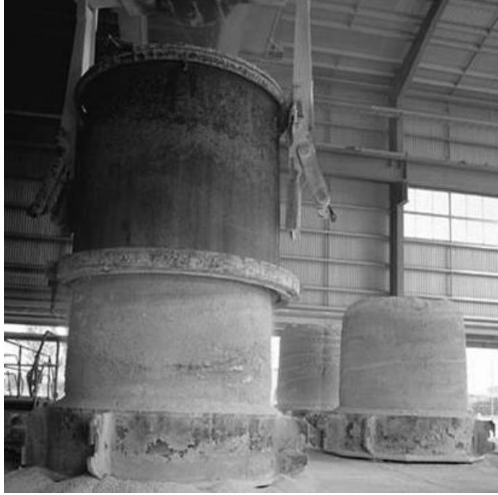
Şekil 2.7. Fırından çıkarılan ingot yapısının görüntüsü
