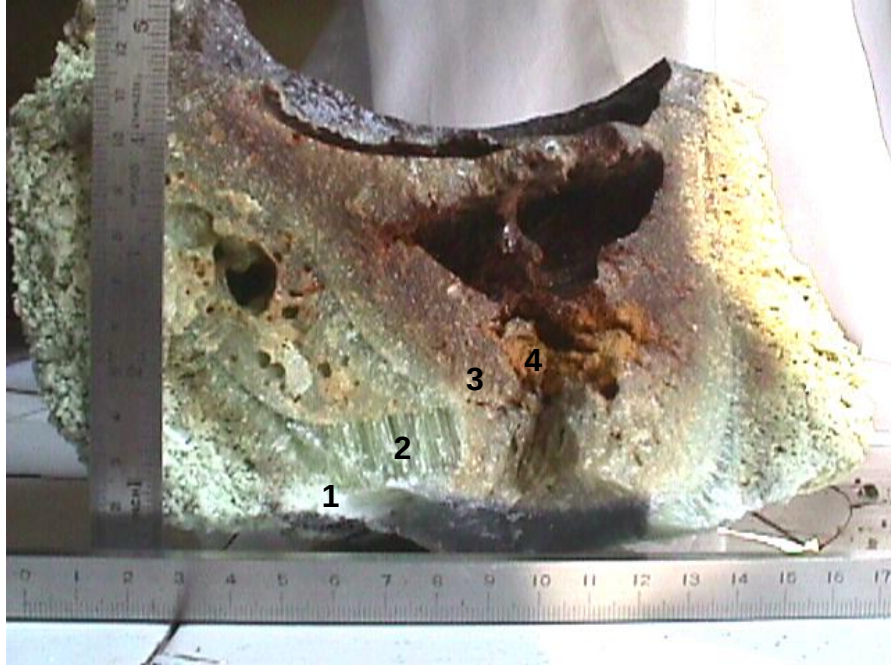
Şekil 4.19. Fırından çıkarılan ingotun ikiye bölünmesiyle elde edilen parça
