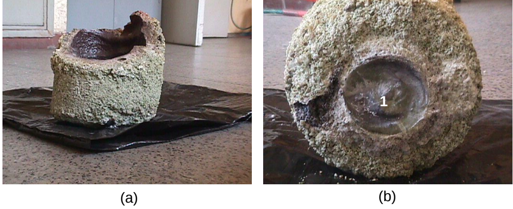
Şekil 4.17. Dşk kalitede sinter magnezyanın ergitilmesi ile elde edilen ingot yapısı (a) İngot, (b) İngotun alt blgesi
