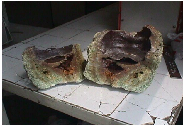
Şekil 4.18. Fırından ıkarılan ingotun ikiye ayrılmasıyla elde edilen paralar
