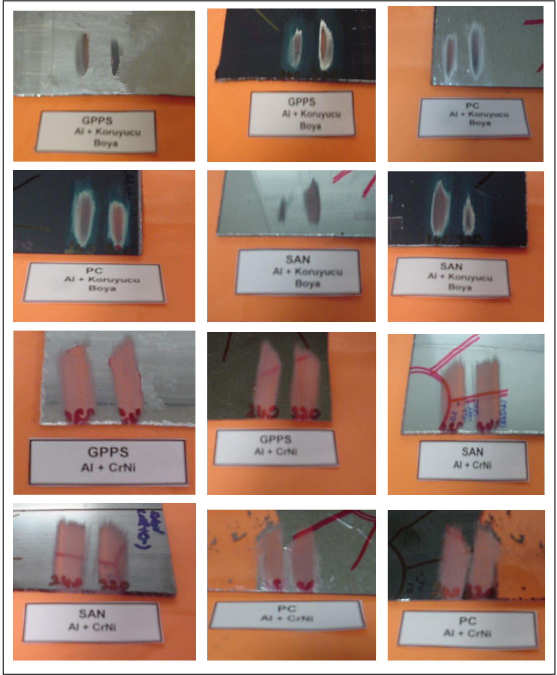
Şekil 5.23 : Arka Yüzü Kaplı Plakaların Soyulma Testi Sonrası Ön ve Arka Yüzden Görünüşleri
