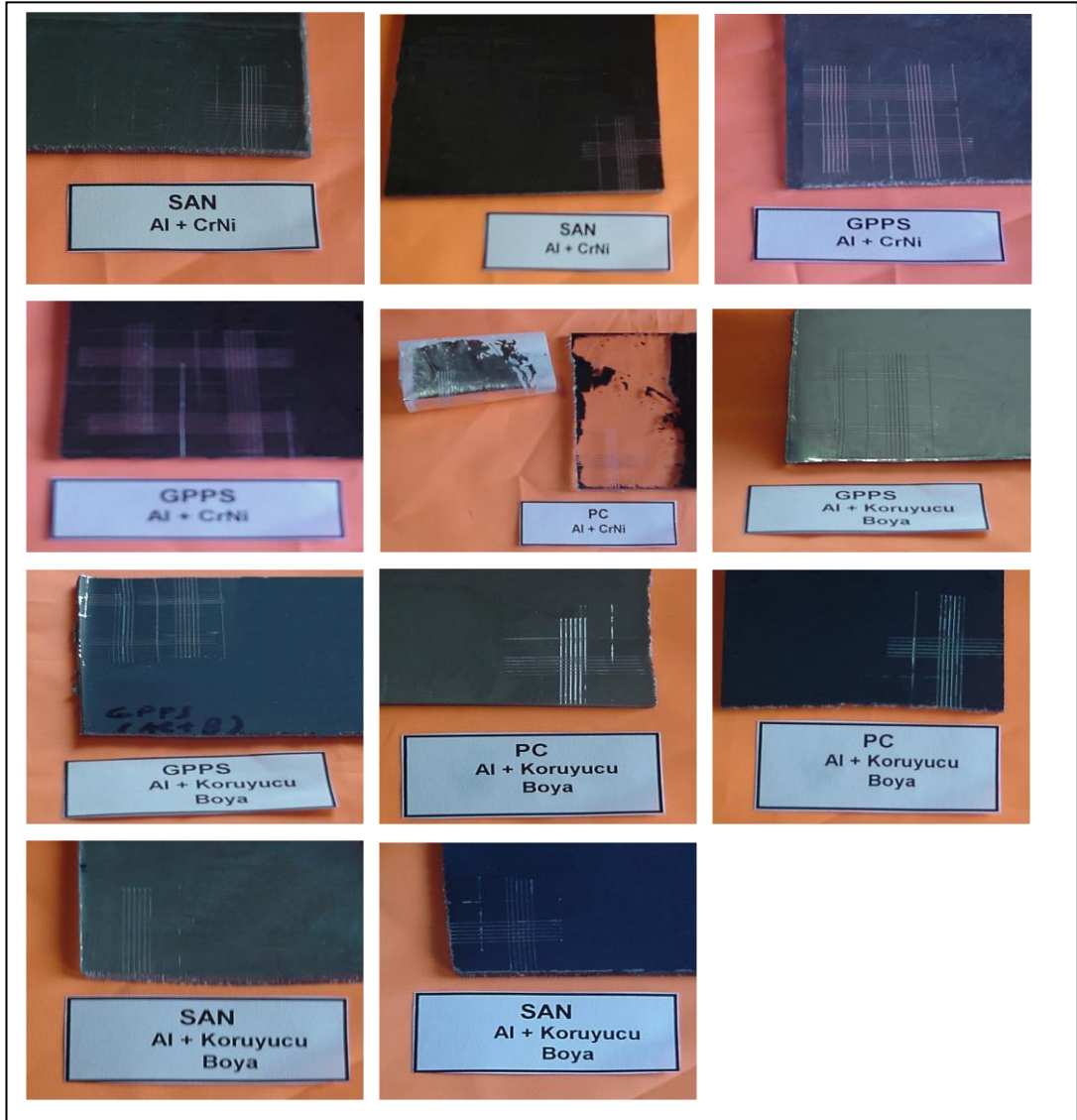
Şekil 5.22 : Arka Yüzü Kaplı Plakaların Tutunma Testi Sonrası Ön ve Arka Yüz Görünüşleri
