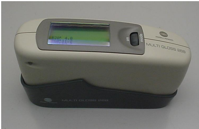
Şekil 4.11 : Konica Minolta Multi Gloss 268 Parlaklık Cihazı
