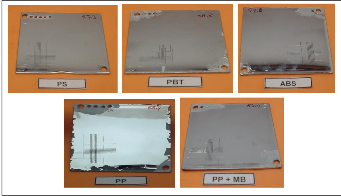
Şekil 5.19 : Kombine Kaplı Plakaların 4 Haftalık Rutubet Testi Sonrası Görünüşleri
