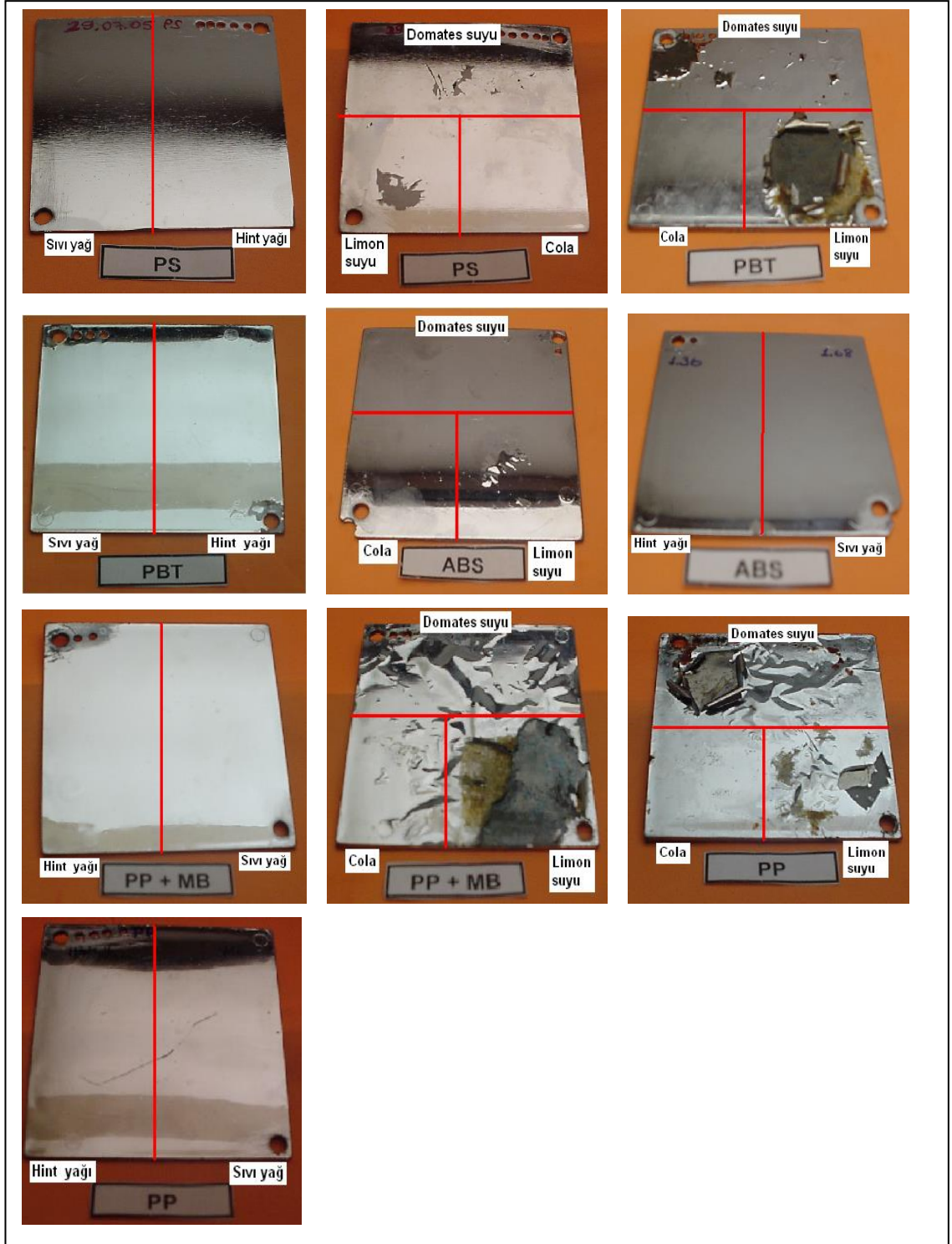
Şekil 5.21 : Kombine Kaplı Plakaların Leke Testi Sonrası Görünüşleri
