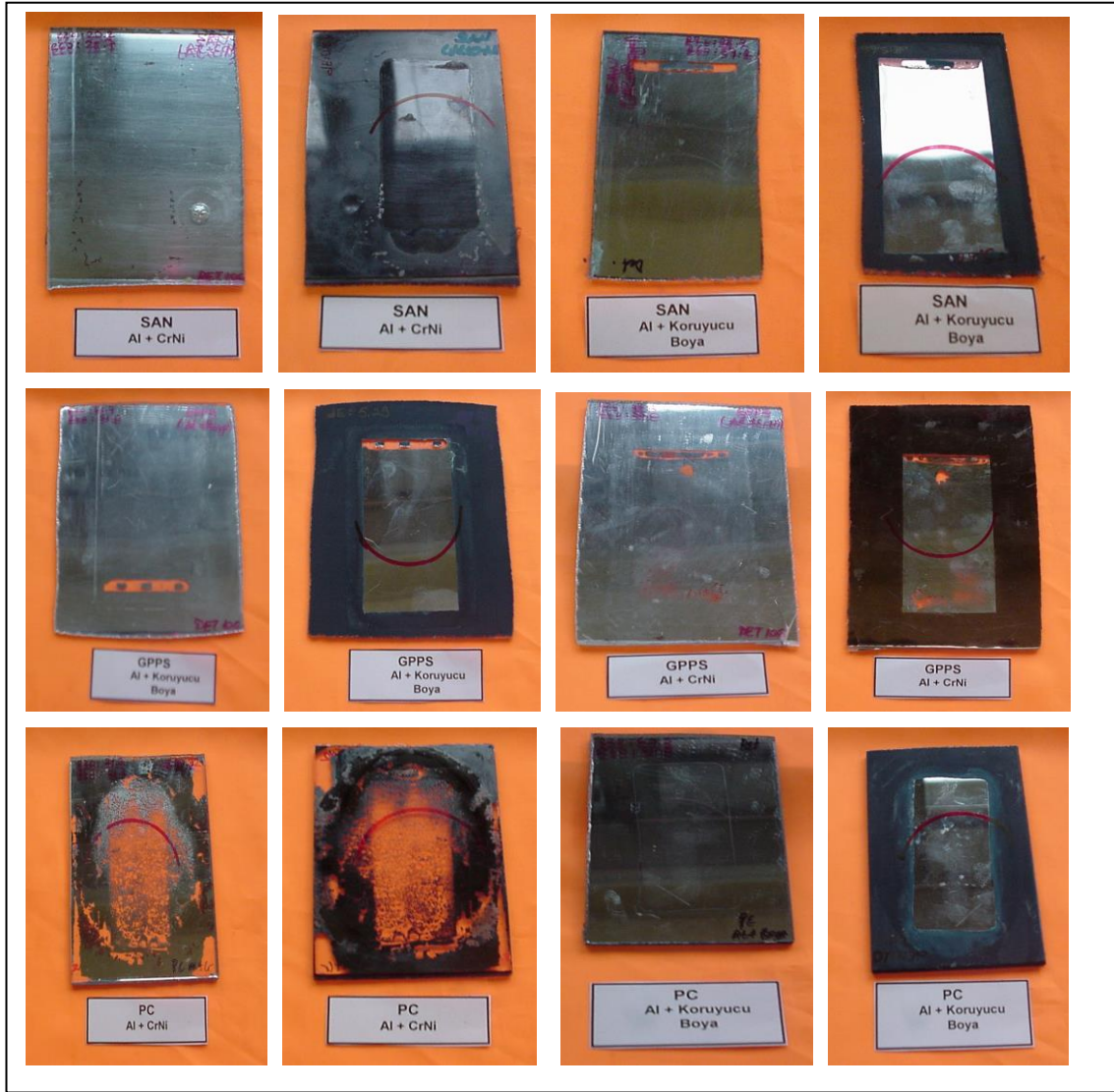
Şekil 5.35 : Arka Yüzü Kaplı Plakaların 10 Günlük Deterjan Testi Sonrası Görünüşleri
