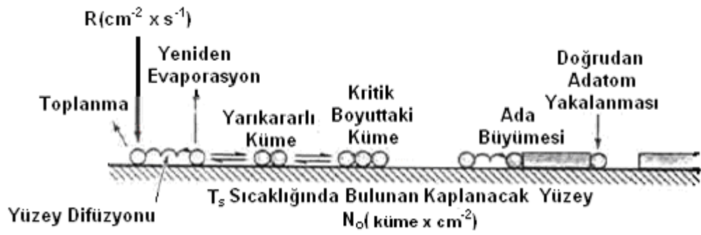
Şekil 2.1 : Üç Boyutlu Nükleasyonun ve Film Büyümesinin Şematik Gösterimi [7]
