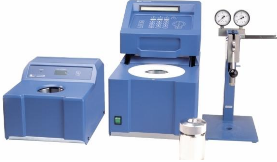
Şekil 5.1 : Isıl değeri analiz cihazı.
