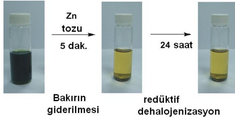
Şekil 4.5 : ATRP karışımına küçük miktarlarda aktif çinko tozu ilavesi çözeltinin birkaç dakika içinde renginin gitmesine ve dipte elementel bakırın toplanmasına sebep olur. Bu işlemde polimer ucundaki halojenlere pratikçe bir etki söz konusu olmazken, 24 saat gibi uzun süreli bir etkileşimde ise halo alkil gruplarındaki halojenler de sudaki protonla yer değiştirmektedir.
