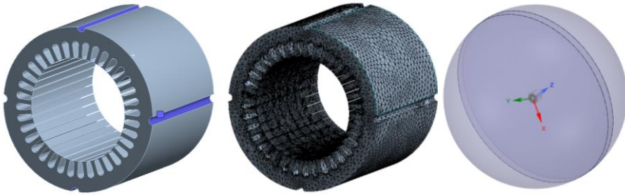
Şekil 6.40 : Stator geometrisi a) sabitleme noktaları b) ağ yapısı c) akustik yapı.
